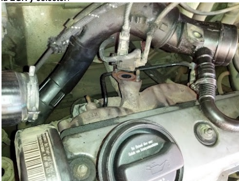
Foto del motor sin la EGR y colector:
