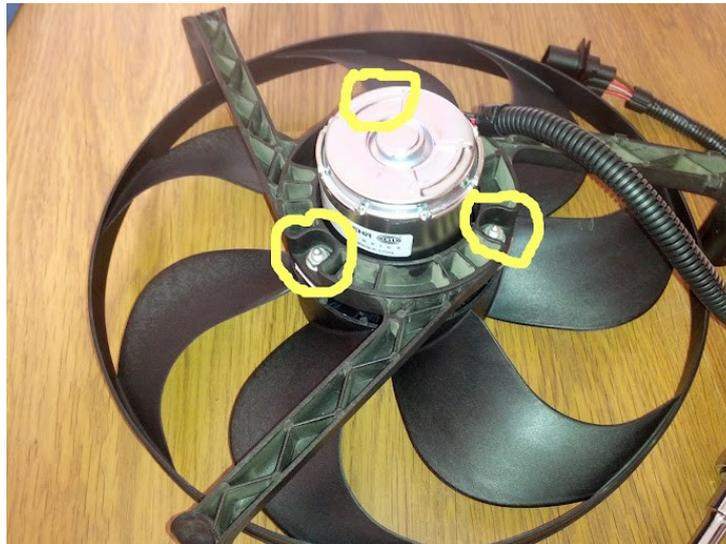
**PASO 5:** Ya solo queda ir a la inversa y montarlo todo. Primero metemos la entrada de aire que quitamos, luego metemos el electroventilador, lo conectamos y ponemos tornillos.
