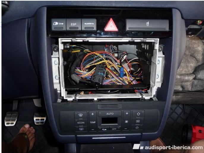
**FOTO:** hacemos hueco bien atrás ordenando tanto cable, jod\*\* con el parrot lo que ocupa con su cajetín. Colocamos y conectamos a ver cómo queda la iluminación integrada en la consola central
