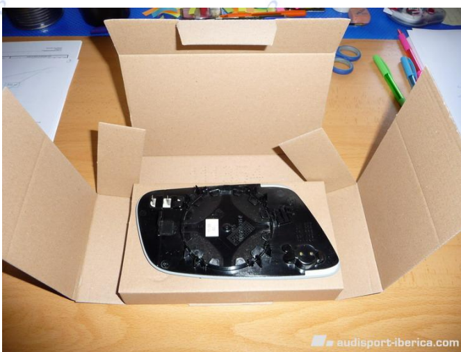
Parte trasera cristal piloto se ve la pila térmica y las dos patillas para conectar
