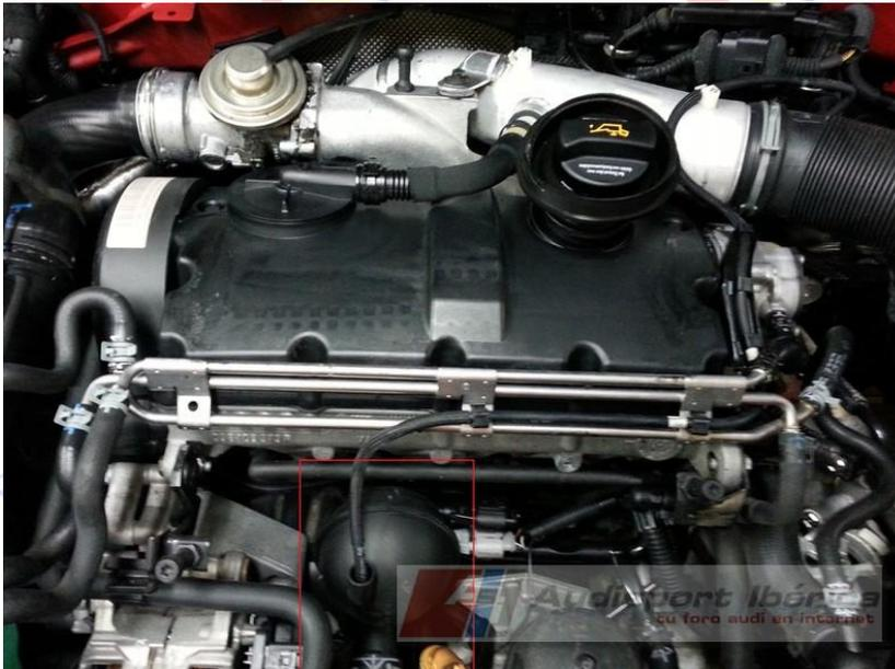
Aquí ya lo encontramos sacado el manguito de plástico que acopla en el termostato, para extraerlo tenemos q girar suavemente hacia el lado izquierdo hasta que quede libre es muy posible que si ya se ha cambiado tenga una o varias patillas rotas, yo al mío me estaba tocando las narices y se las corte, supongo q su sentido tendrá, pero en cuanto quede montado con el calor y la presión el termostato se queda pegado a la goma y no se mueven
