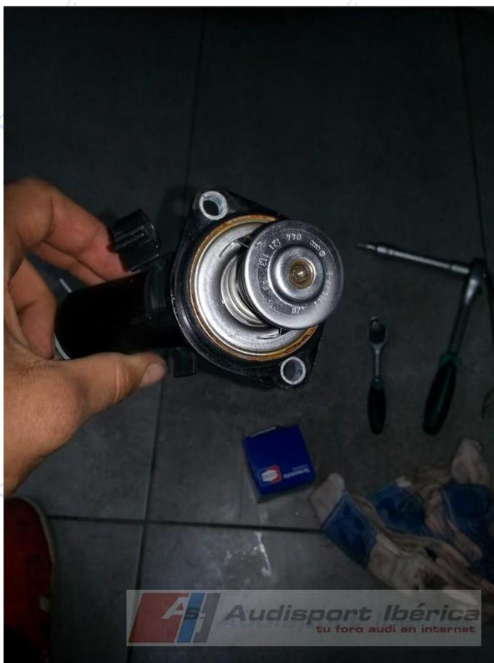
5° Para el montaje hacemos los pasos inversos introducimos el termostato nuevo, a continuación ponemos la junta de goma ponemos el manguito. Os recomiendo dejar metido el tornillo inferior porque a mí me tocó bastante las narices para ponerlo a pulso.
