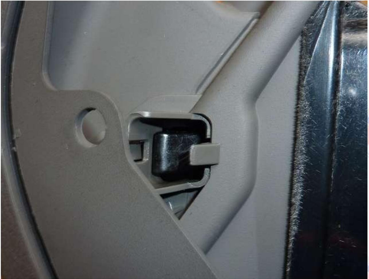
Después hay que desmontar la guantera, quitar los cinco tornillos que la sujetan tres arriba y dos debajo, por último soltar la cerradura sacando el tornillo lateral izquierdo y tirando sale.
