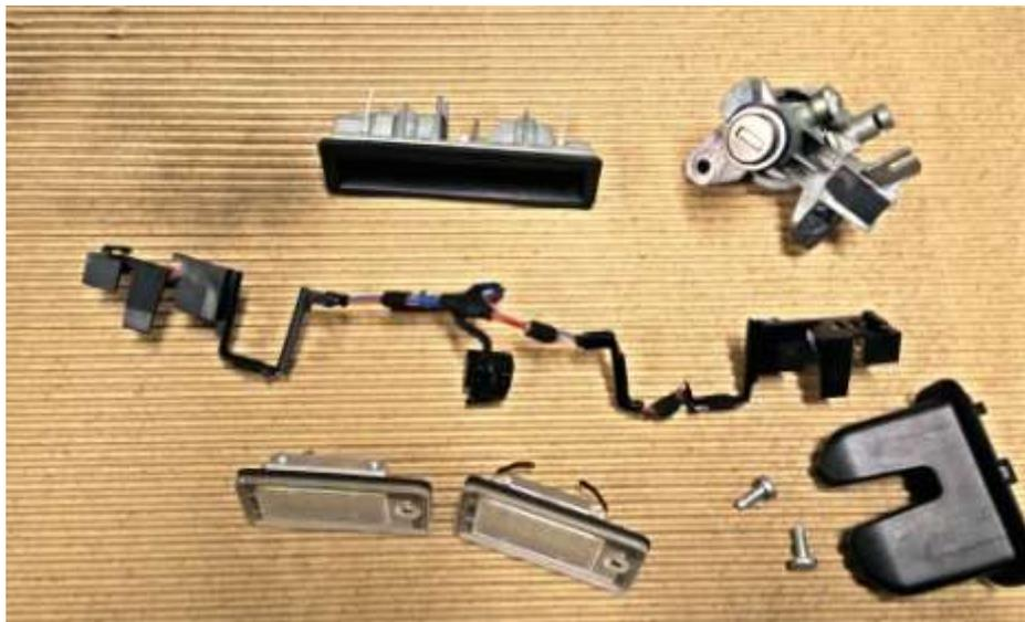
Para montar, hacemos a la inversa, y yo aproveché para poner unas luces LED canbus específicas para el coche, y unos tornillos de acero inox con cabeza allen, así evitamos que vuelva a suceder...
