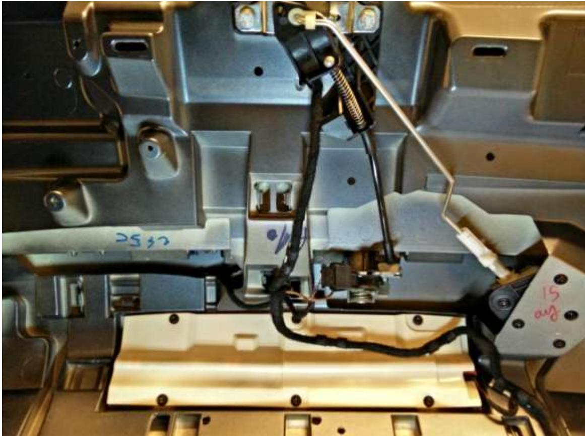
Una vez todo suelto, la placa de aluminio va solo sujeta con cuatro tuercas de 10mm, carraca pequeña y salen fácil.
