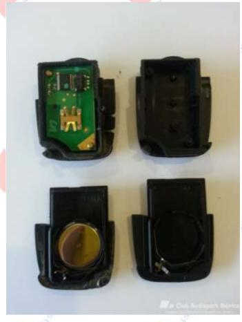
3°- Debemos pasar los componentes (pila y placa) de la llave vieja a la nueva. La pila sale fácilmente, pero si hace falta podemos utilizar un destornillador plano para hacer un poco de palanca. Sacar la placa es un poco más complicado puesto que va sujeta por 2 tornillos pequeños, uno en el extremo superior izq. y otro en el extremos inferior derecho.
