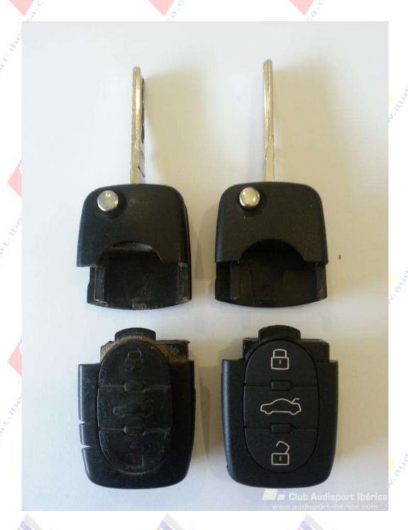
2º- Separamos, de la parte de abajo, la parte delantera y trasera, donde va la pila, la placa... Para ello ponemos la llave de perfil y cogiendo de los perfiles que sobresalen tiramos hacia fuera.
