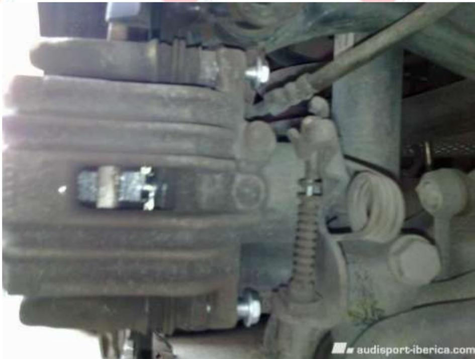
Como en el desmontaje, fija del 15 en la tuerca interna para que no gire loco el tornillo y de estrella de 13 para apretar ambos tornillos.
