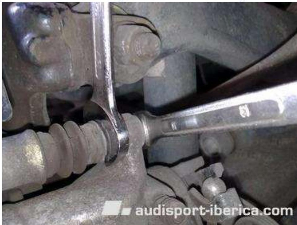
Una vez quitados los dos tornillos, el cuerpo de la pinza se resistirá a salir... nada, con un poco de palanca ayudados de un destornillador, no se resiste. Recordad que el coche sigue en vilo, por lo que cualquier movimiento brusco puede jugarnos una mala pasada.
