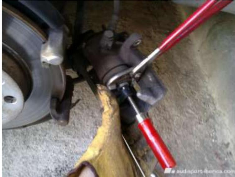
Aquí tenéis ya el pistón casi metido del todo, pero no es necesario meterlo más ya que hay sitio para el grosor del disco y de las nuevas pastillas. Si os quedáis cortos, con apretar un poco más es suficiente.
