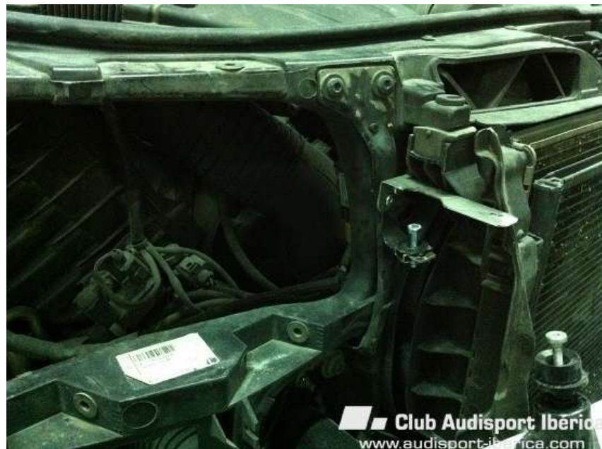
Diferentes vistas de los soportes realizados para los faros de forma artesanal.
