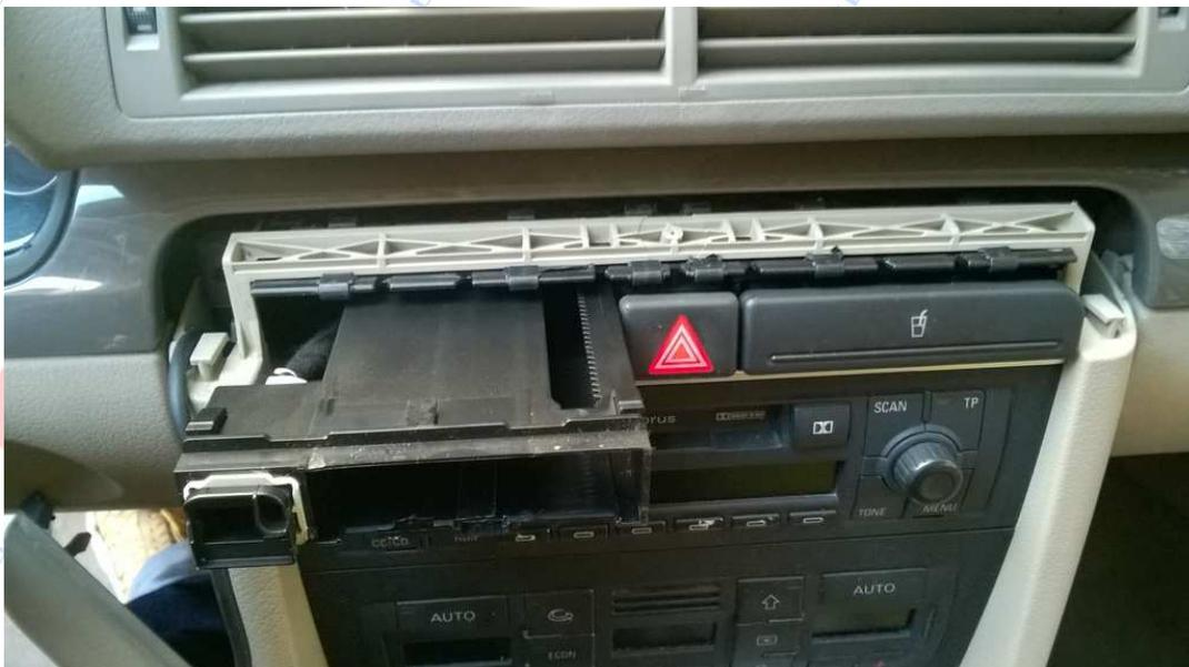
Para sacar el blíster tenéis que soltar dos pestañas superiores que se ven a través del armario
