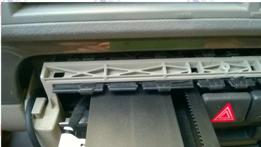
Soltamos el cable que va al ESP y el cable que va al tarjetero (del que sacaré los +12V)
