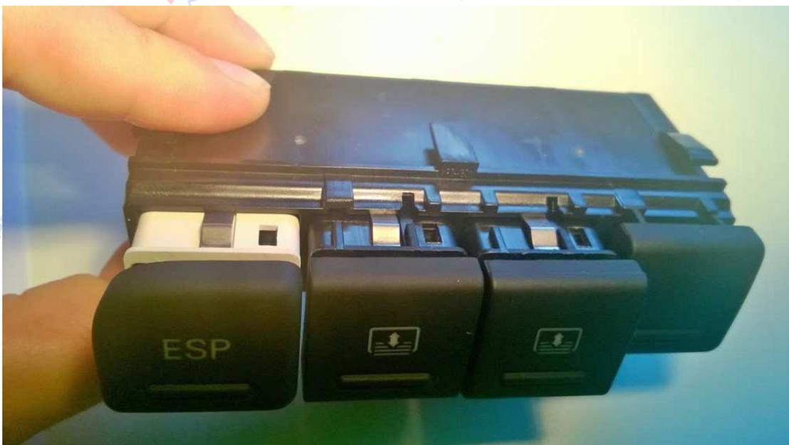
No sé si apreciáis que el pulsador para la segunda puerta (tercera posición) no se puede poner porque el blíster tiene un nervio y el botón unas guías que no encajan...
