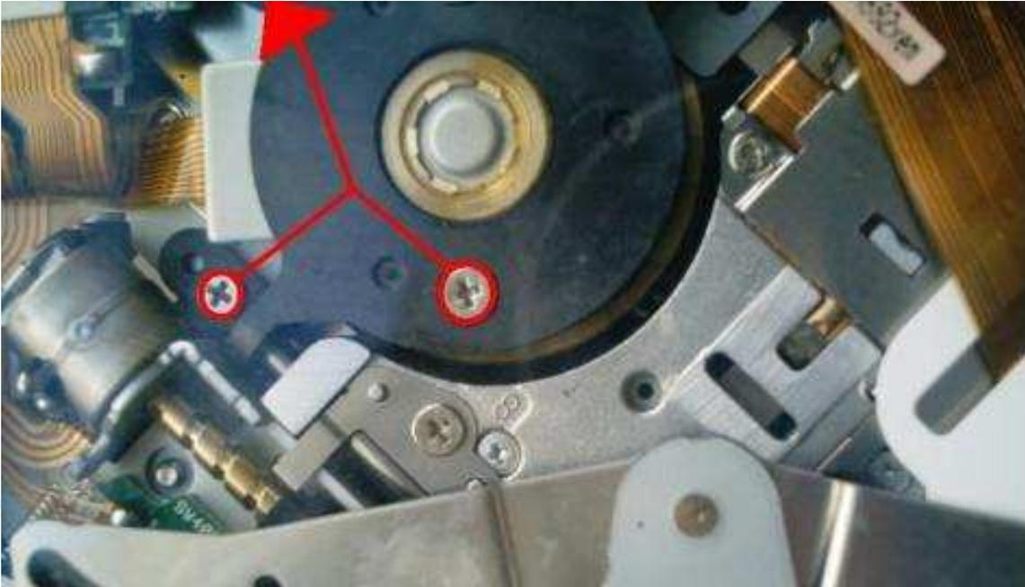
Vamos a desoldar la faja de la lente. Cuidado de no utilizar un soldador demasiado potente. Yo puse un destornillador debajo de la faja en el sitio del punto de soldadura para que se despegue nada más aplicar le soldador
