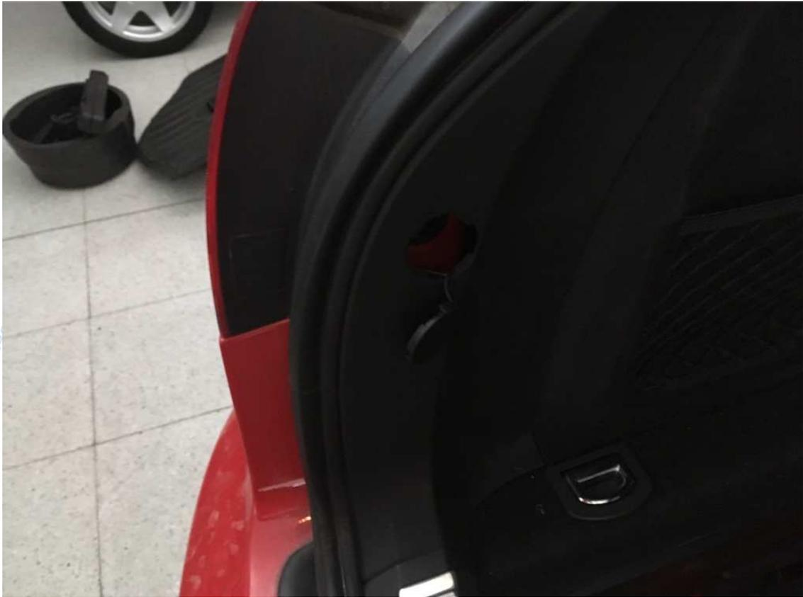
4o paso sacar embellecedor de montante bajo. Tiene 4 tornillos torx de 25 dos de los cuales llevan un tope de plástico para apoyar la moqueta.
