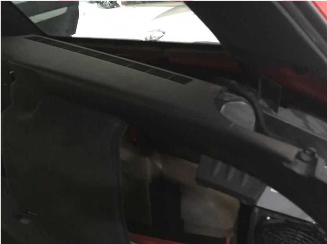
7o paso. Si lleváis la radio con el ampli. Sacarlo. Son dos tornillos de 13 y uno de 10. Sacar conexiones y fuera.
