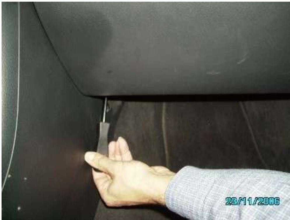
Retiramos la guantera tirando ligeramente hacia el asiento, osea hacia atrás, la dejamos apoyada en el suelo y retiramos el conector de la luz de la guantera, tiene unos clips laterales, pulsar los dos al mismo tiempo y tirar.
