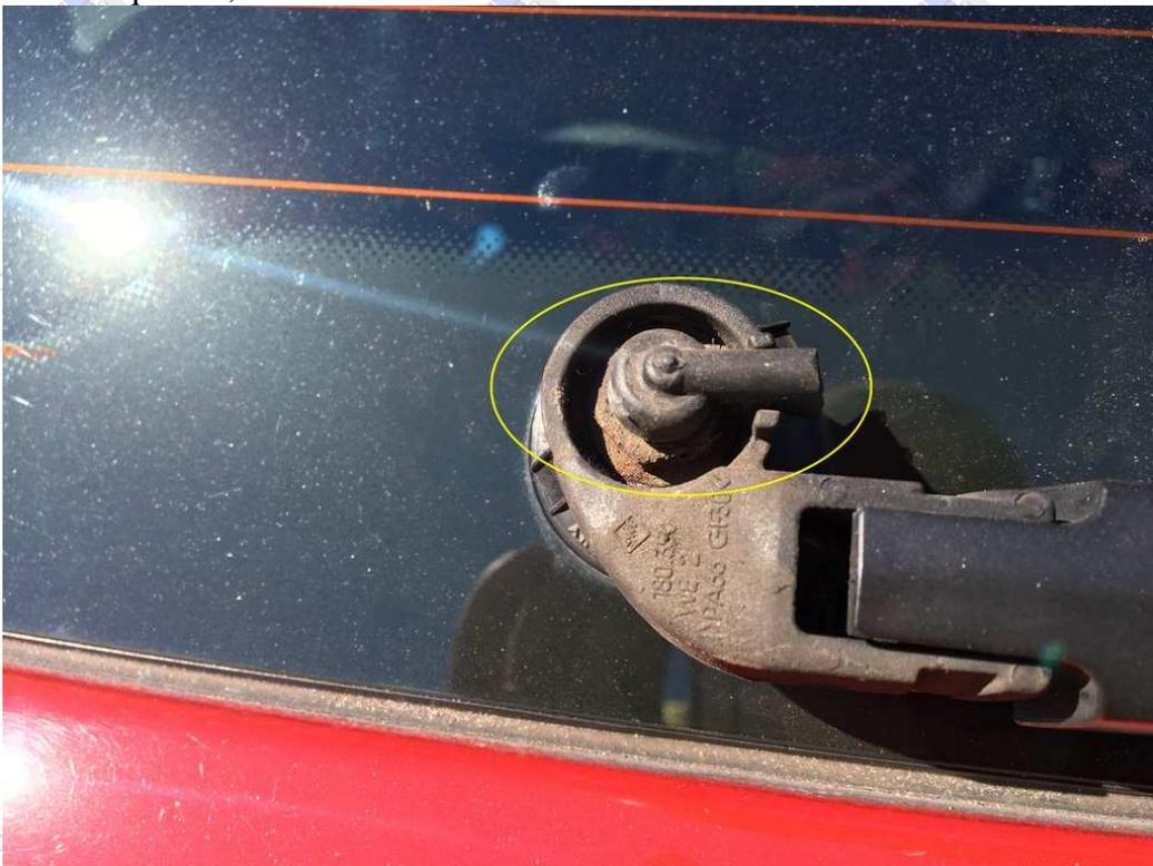
Retiramos el eyector de agua. Sale simplemente tirando hacia nosotros. Va a presión.
