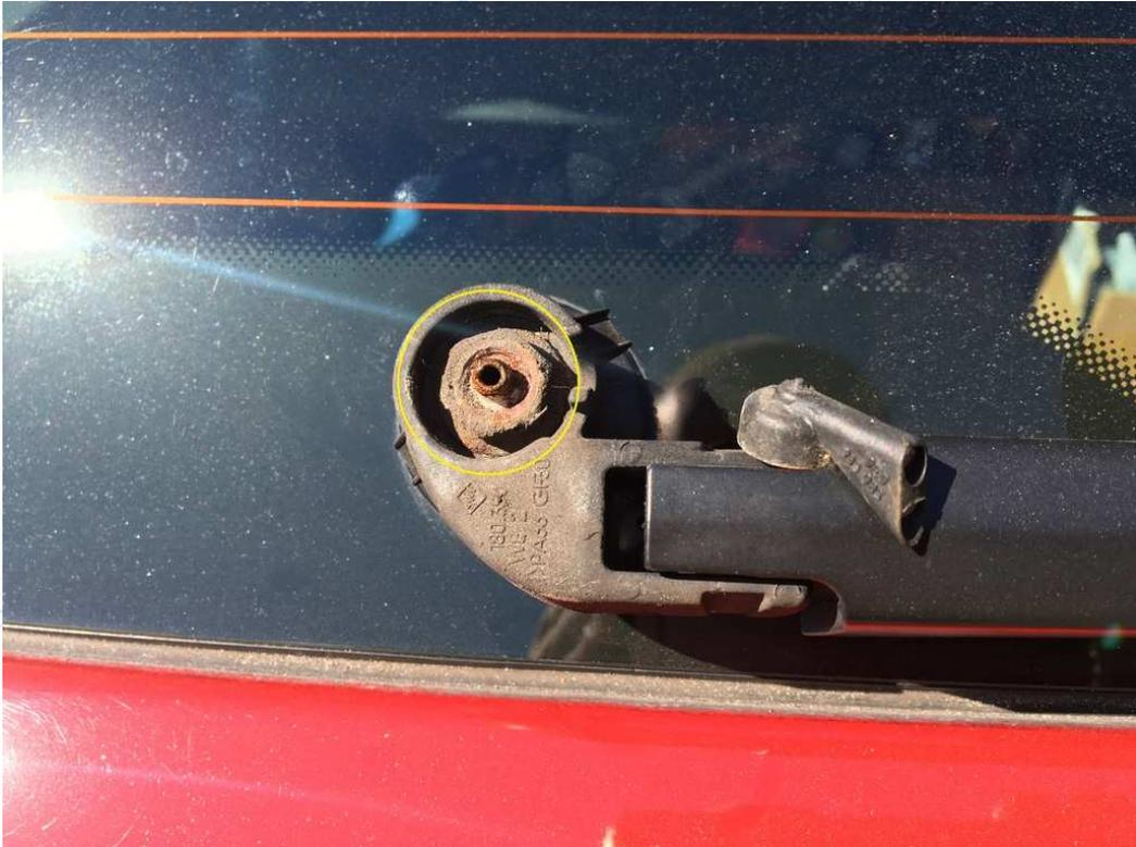
Ahora retiramos la tuerca M8 que sujeta el brazo al eje del motor.
