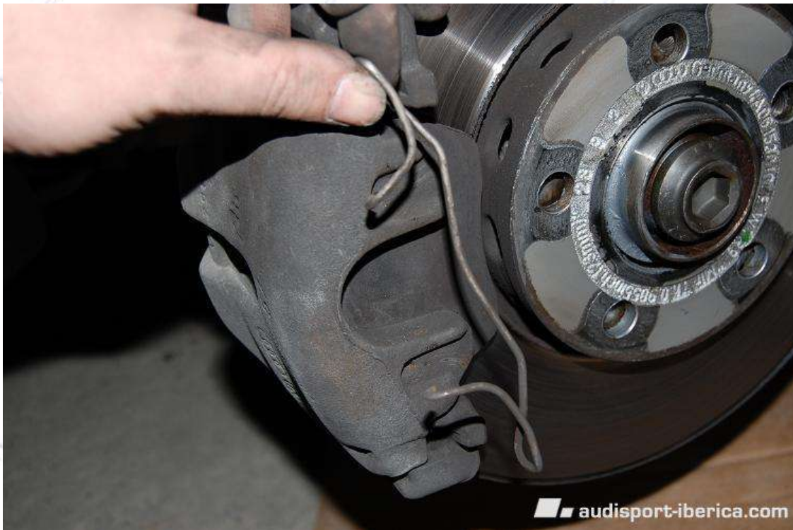
EL conector del avisador de desgaste de las pastillas.
