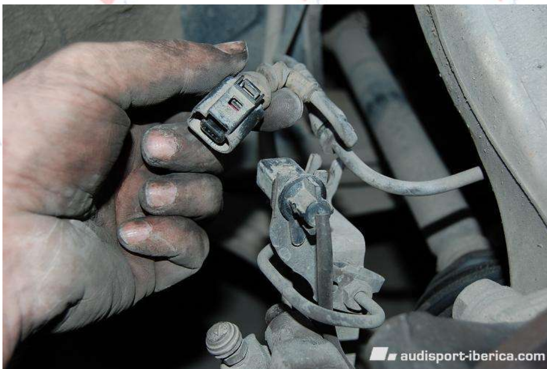
EL conector del avisador de desgaste de las pastillas.
