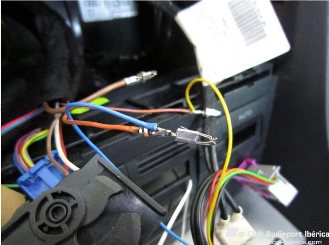
En el caso del positivo y negativo, como eran más cables, soldé un trocito de cable sobre el terminal e hice las conexiones en el otro extremo, así si necesito conectar algo lo hago en ese cable.
