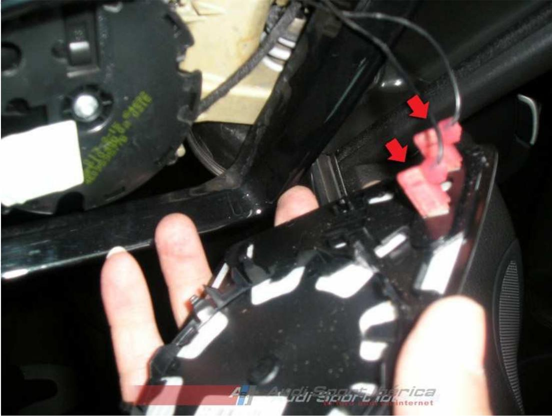
Después de insertar el espejo con cuidado, colocamos de nuevo la carcasa inferior.
