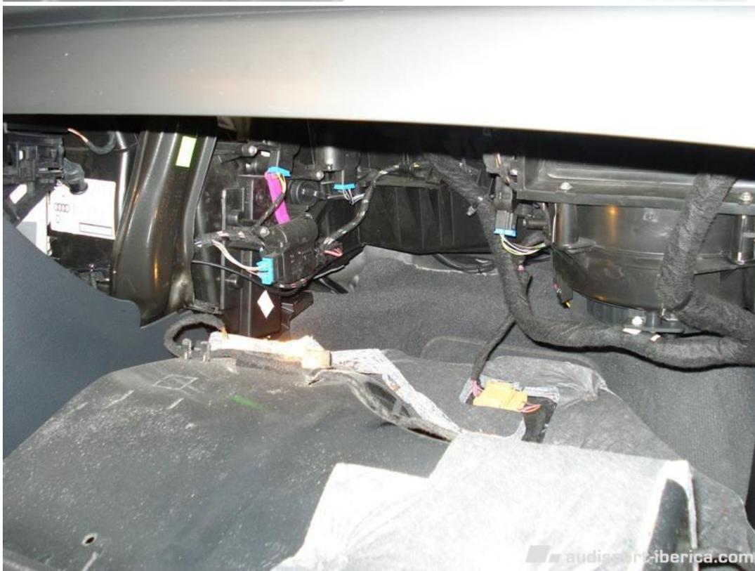
Para retirar los conectores del alumbrado, hay que abrir un poco las patillas y luego retirar el conector hacia atrás.
