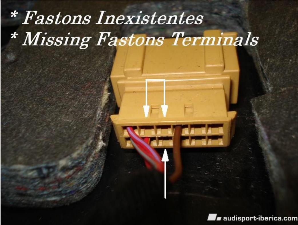
Como podéis ver en el conector hembra del vehículo (foto superior), ya tenemos las conexiones del airbag (en un color ligeramente amarillo), pero en el conector macho son inexistentes, es aquí donde hay que insertar los cables que vienen del conector (amarillo), pero hay que adivinar donde va cada uno.
