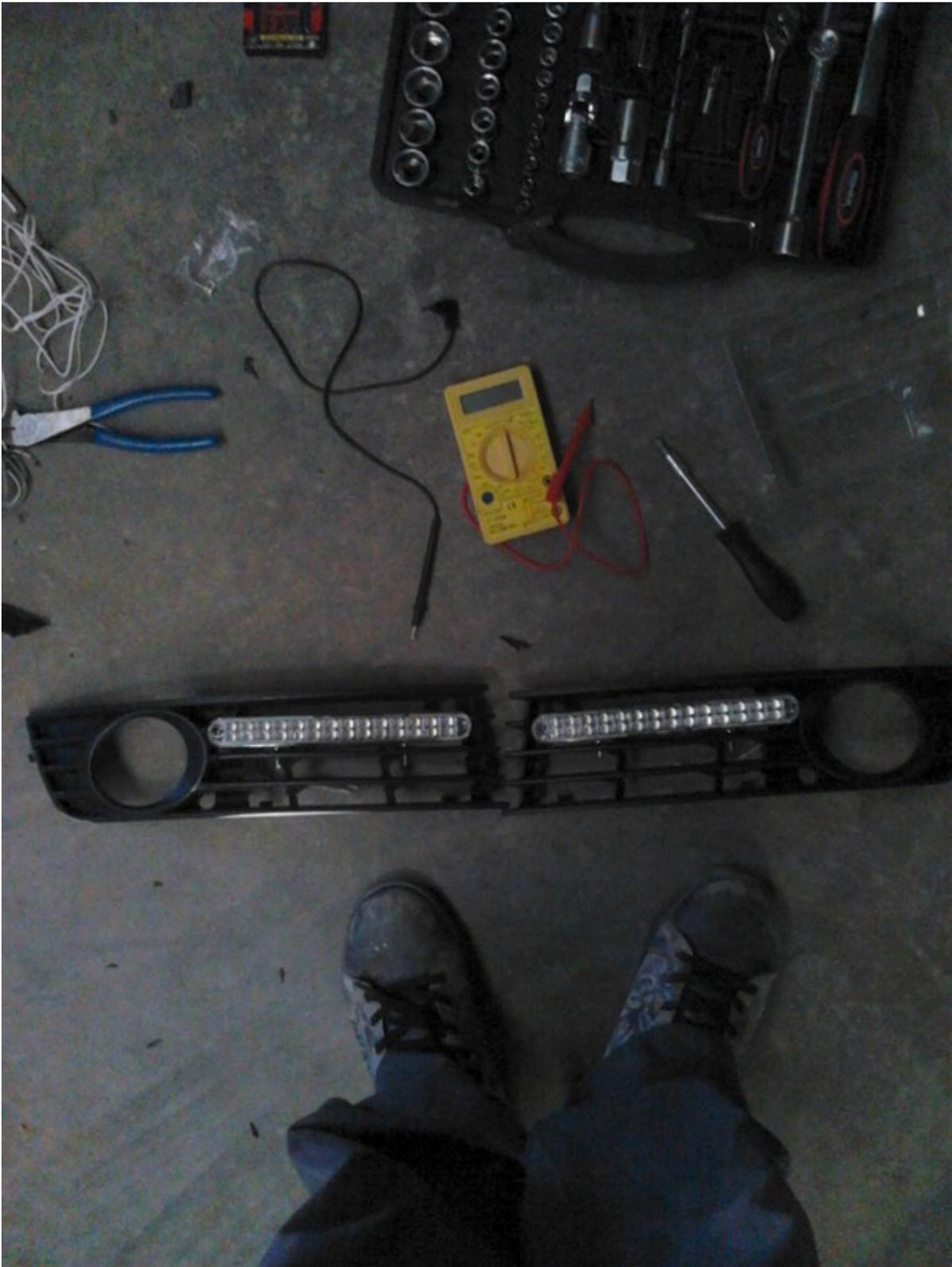
Una vez colocadas las luces en las parrillas, le colocamos una clavija para poder ponerlas y quitarlas rápidamente, en caso de problemas en la ITV solo tendríamos que quitar las parrillas de los antinieblas y desconectar las clavijas y así poder retirarlo todo sin problemas.
