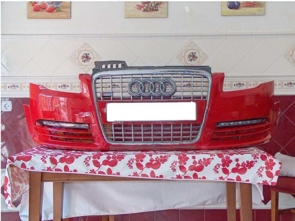
Pues ahora toca colocar el para golpes en su sitio, recordar que tenéis que pasar los cables a la parte superior para hacer las conexiones
