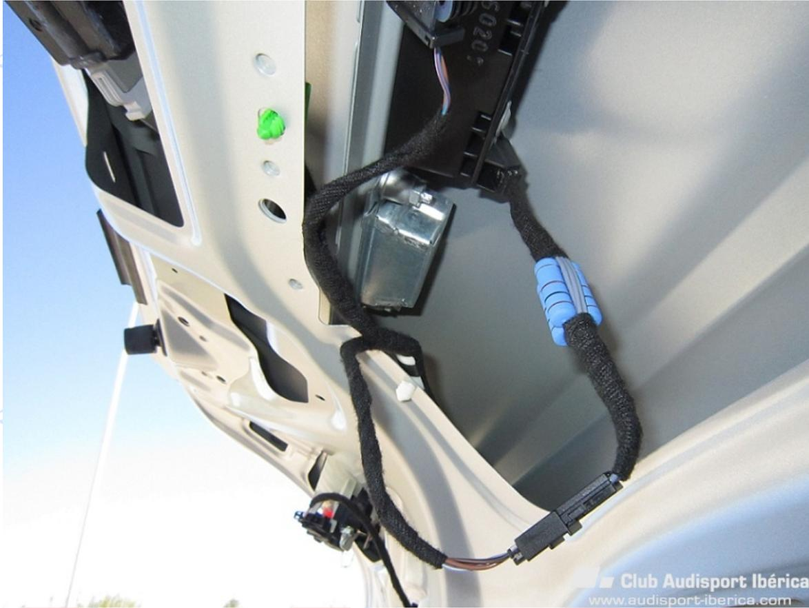
Para evitar que la resistencia se aproxime al guarnecido del portón o roce contra la chapa, he colocado una base adhesiva para bridas y he fijado el cable de la resistencia a ella.
