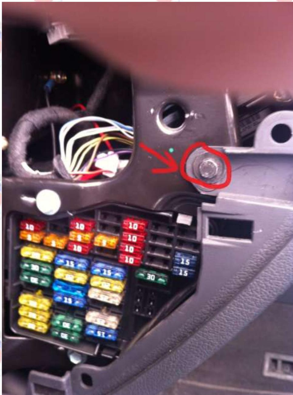
Debajo junto a la palanca de apertura del compartimento del motor tenéis el segundo tornillo a sacar marcado en el círculo rojo.
