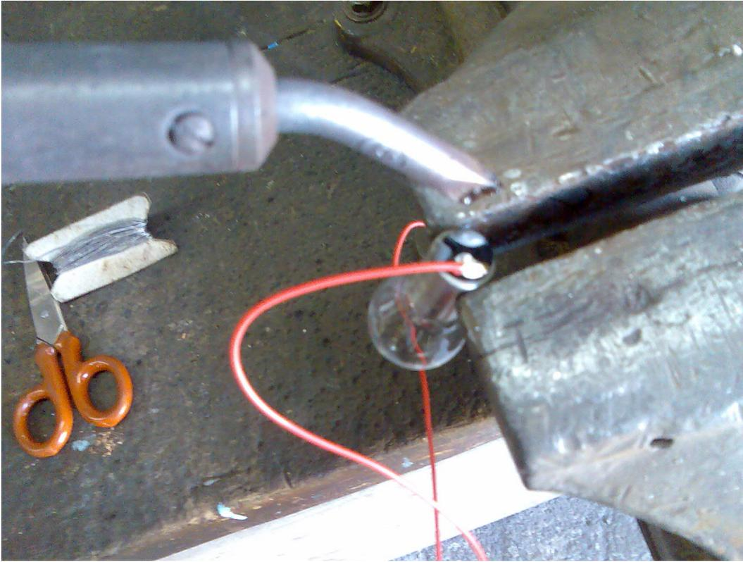
He aislado bien esta soldadura que no tiene que ser muy abultada para que no moleste a la hora de que la patilla del porta bombillas haga conexión col la el otro conector de la bombilla (el de 21w para antiniebla)
