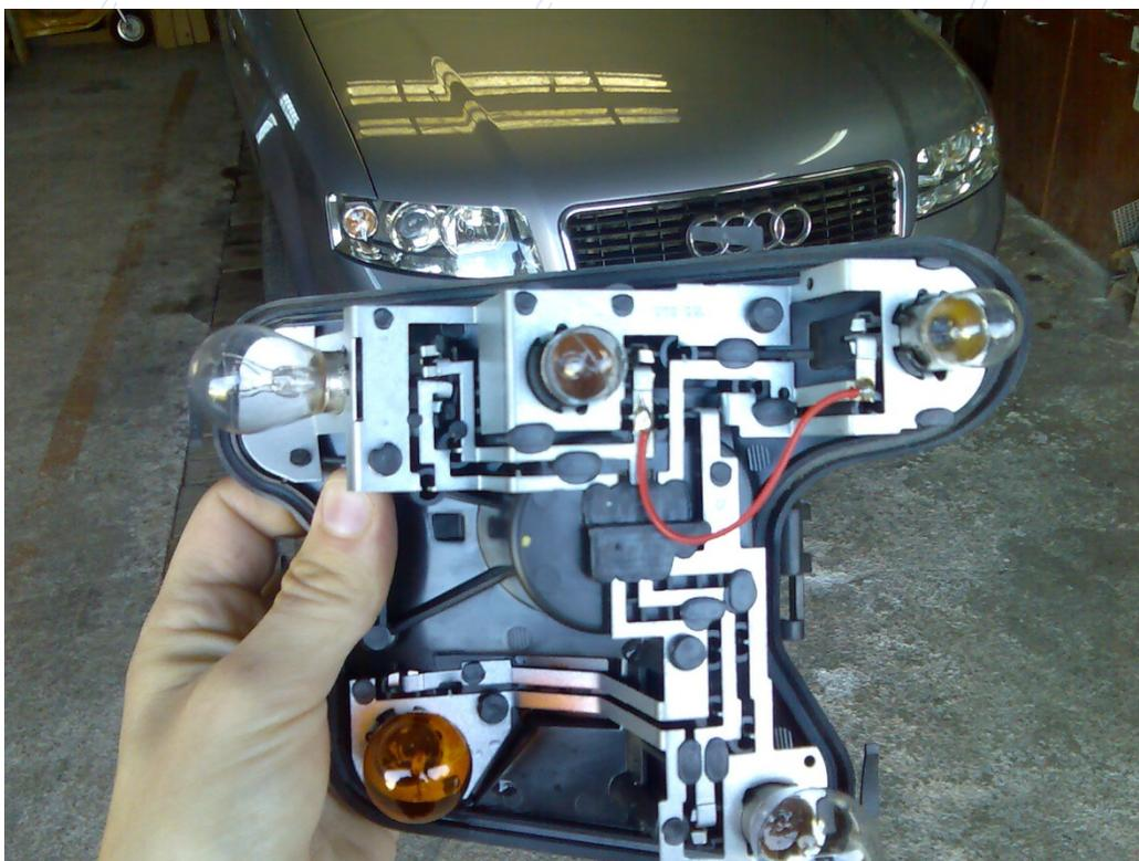
Comprobamos con el tester o con una lámpara de pruebas que lo hemos hecho todo bien y de que no hay nada en corto y a montar. El resultado: En posición
