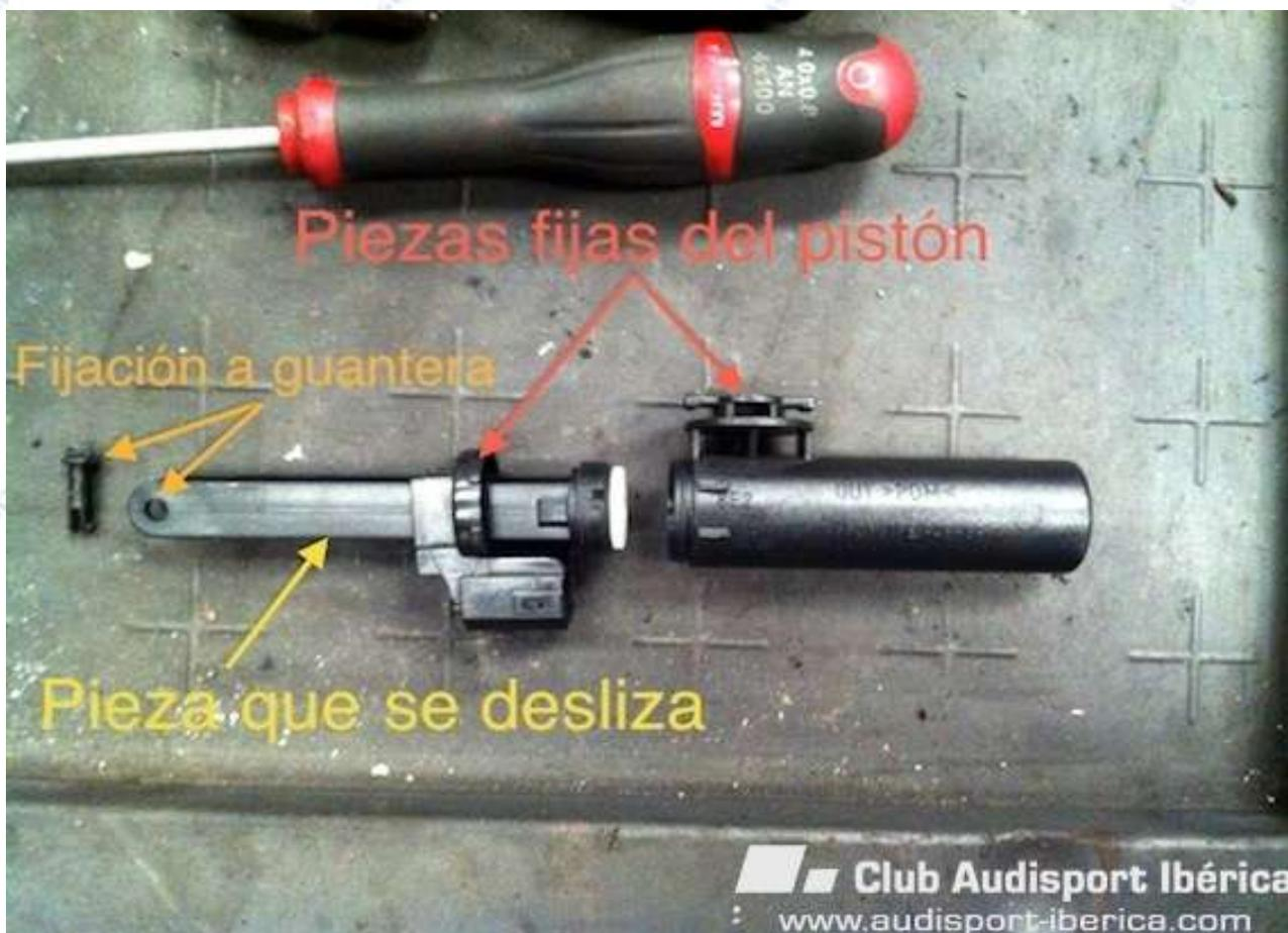
A la izquierda podéis ver el pasador que se usa para enlazar la base del pistón a su sujeción en la guantera.
