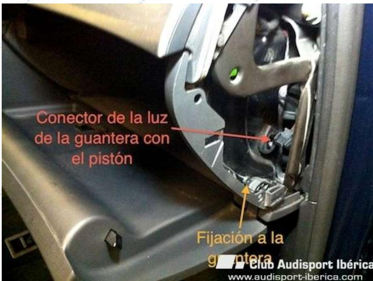
Como veis, en la zona derecha, está el conector de la bombilla, que va unido al pistón. En la parte inferior, veis el orificio en el que se fija la parte inferior del pistón, mediante un pasador, que aparece en la foto del comentario anterior, en la zona derecha.
