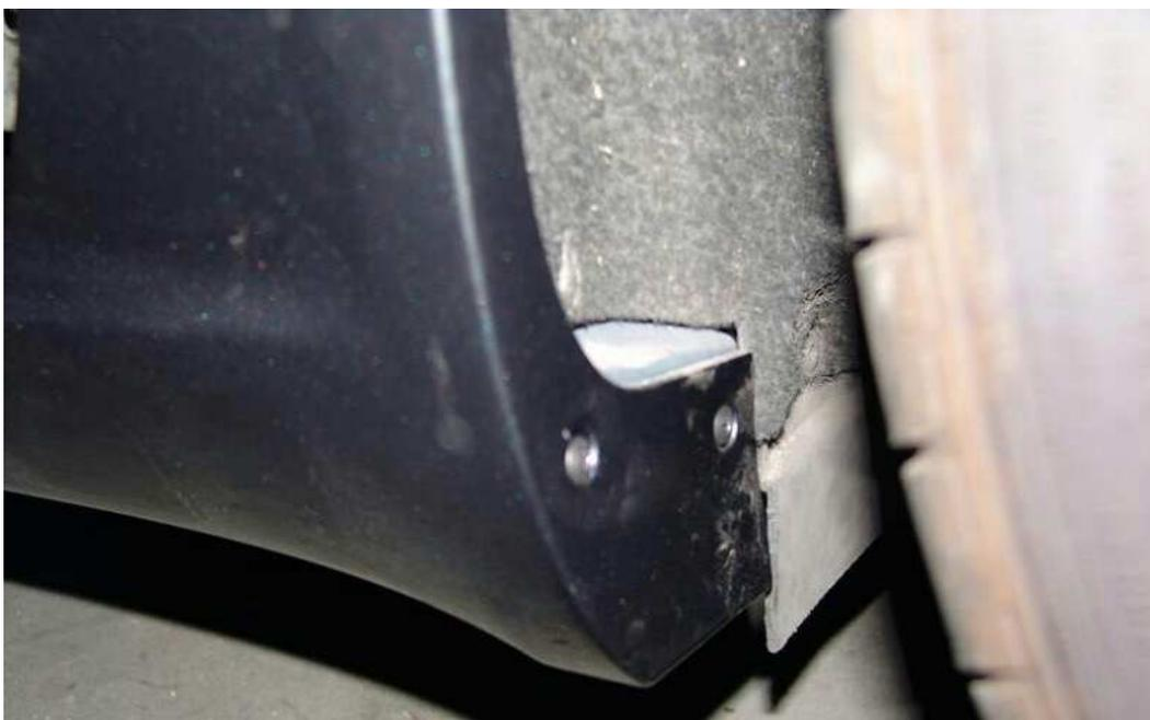
Detras se aprieta en los soportes que vienen con los faldones dtm, aqui se aprecia porque hace falta cortar el plastico.
