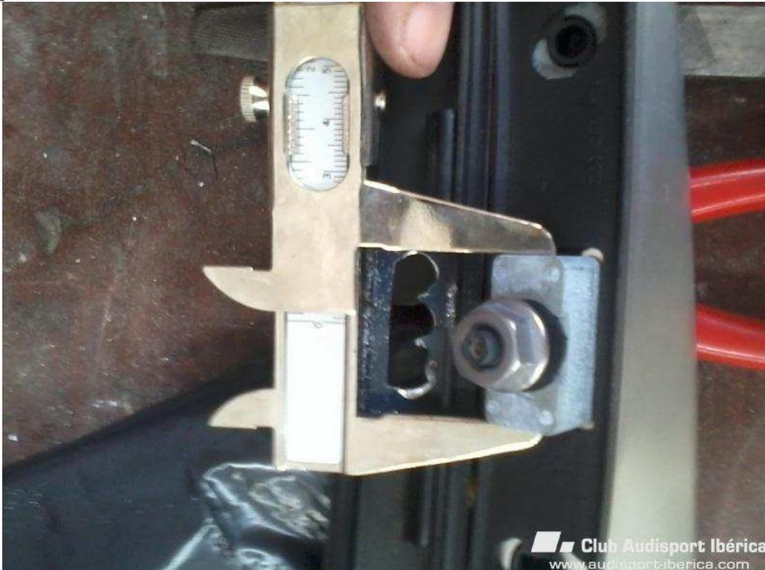
Comprobamos en la regleta y vemos que tenemos un poco de margen, no hace falta que el taco de la barra entre ajustado, si le queda un milímetro de holgura es bueno por si un día hay que desmontar, no vaya a ser que de ir muy justa y toque desmontar, se doble la regleta, tener cuidado ya que son de aluminio y se doblan con mucha facilidad.
