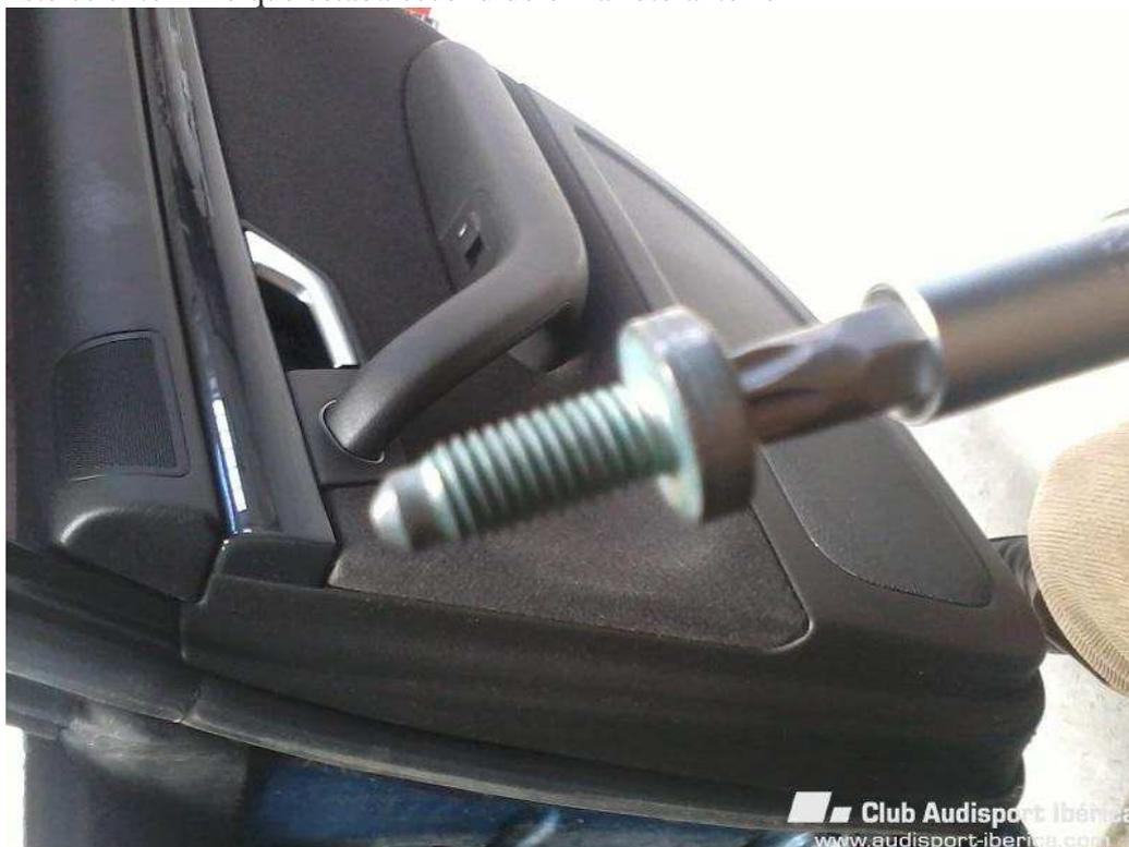
Quitamos haciendo palanca el tramo de forro por encima de la puerta trasera. No hace falta quitarlo del todo, como se ve en la imagen esta visible el tornillo de la barra y se puede apretar la tuerca fácilmente
