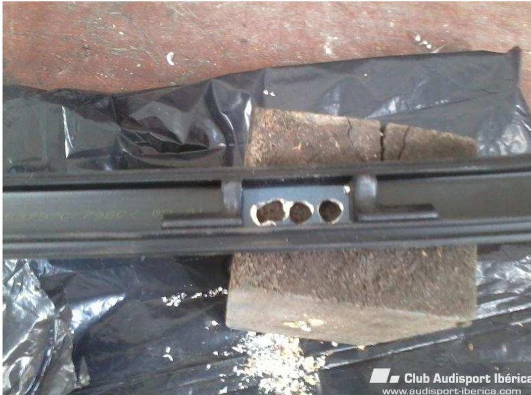
Con ayuda de una cinta o otro aparato de medición, medimos la largura del taco de la barra para comprobar hasta qué punto debemos que abrir el hueco en la regleta, para mí ha sido trabajoso ya que con una lima, aún siendo buena, se tarda lo suyo, pero lo conseguí poco a poco.
