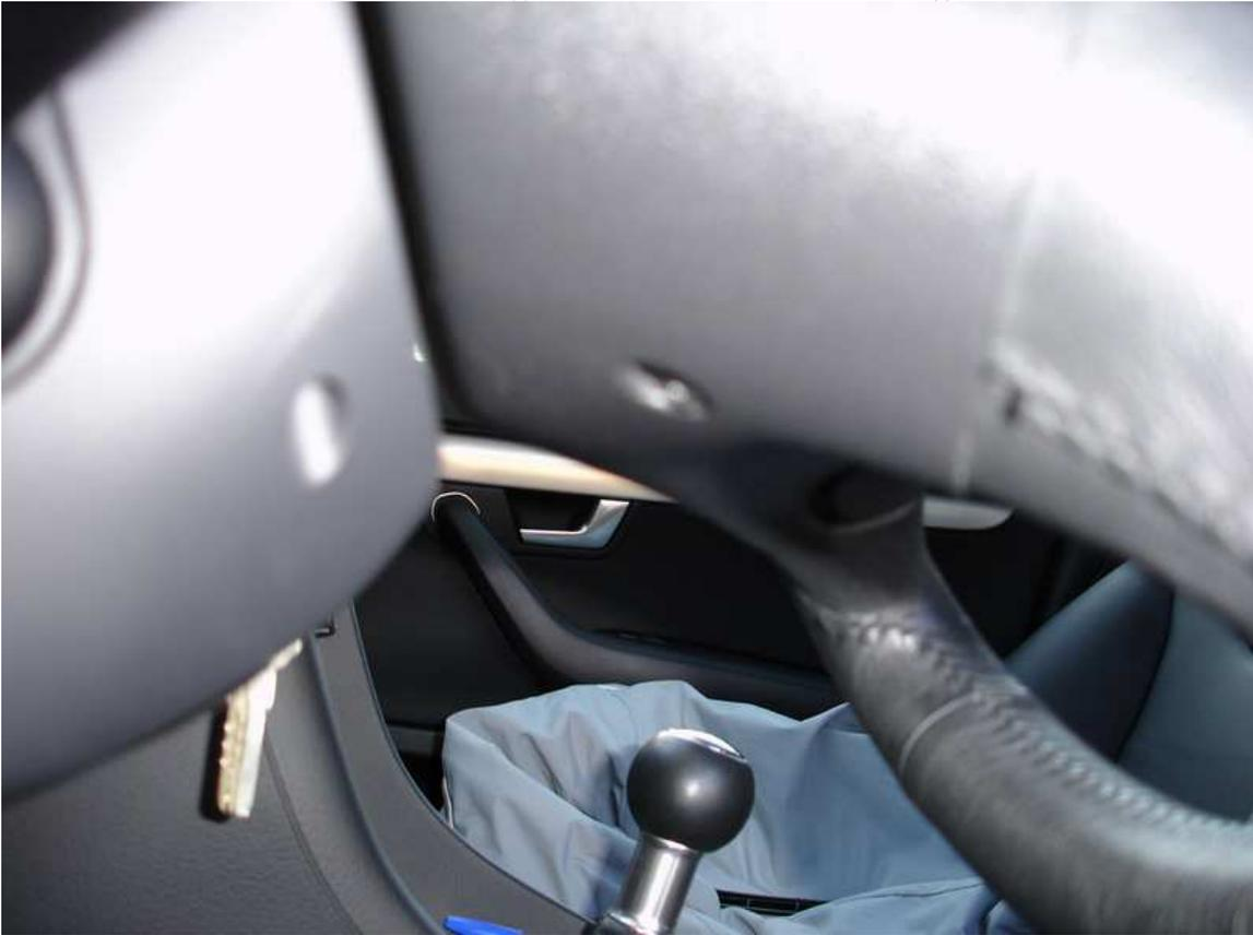
Una vez tengamos estos dos tornillos fuera... podremos retirar la tapa del airbag, pero con cuidado, pues aun tendremos que sacar los conectores del anillo del airbag (conector amarillo) para poder retirarlo del todo.
