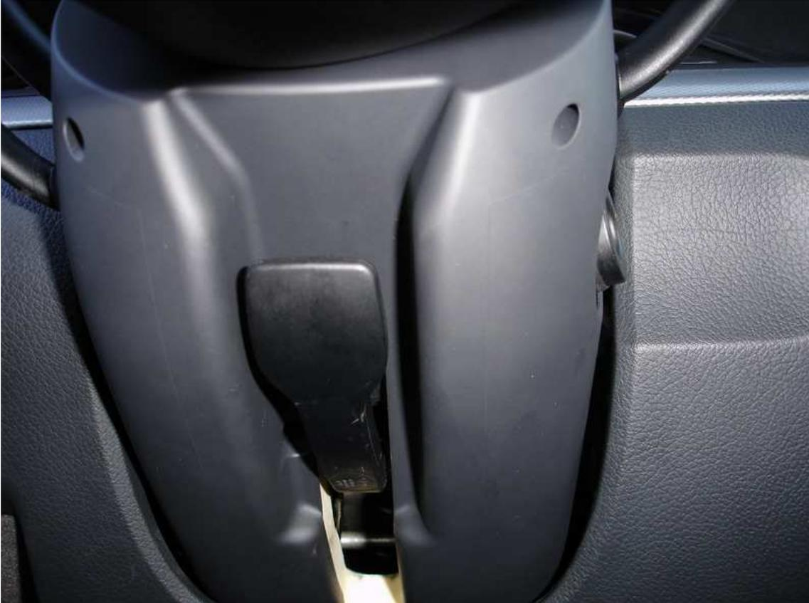
Una vez los tornillos TORX T9 estén fuera, podemos sacar la superior, y sacar el trozo de piel que tenemos con unas grapas que hay en la parte de abajo. De esta manera, tendremos el plástico de la parte superior del volante fuera, y el de abajo, lo podremos deslazar un poco, ya que no hace falta sacarlo.
