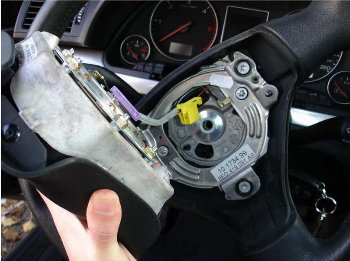
Una vez retirado el conector amarillo, tenemos ya acceso libre al conector del propio airbag en el volante. Lo sacamos y ya tendremos acceso directo al volante. El volante lo sacaremos con una llave FORCE M12 y una buena carraca. Es tan tonto como una vez fuera el tornillo de la llave M12, estirar hacia vosotros....
