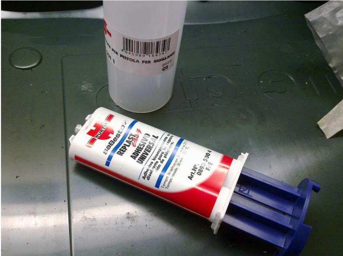
Este producto viene con un adaptador para colocar en una pistola estándar de las de aplicación de silicona. Hay que trabajar rápidamente porque en algo más de un minuto la mezcla no se puede trabajar.
