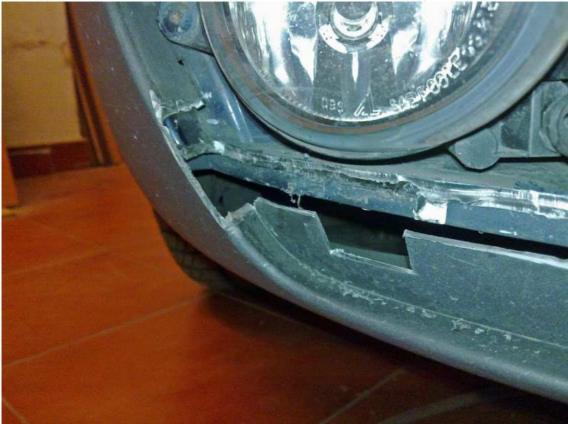
Para el relleno de la zona de paragolpes que quedaría visible, he utilizado pequeños trozos de la zona del propio paragolpes retirada anteriormente, pegando por el interior un trozo dado forma con pistola de calor y recortando con mayor precisión un trozo que cubra el hueco dejado al realizar los cortes. El adhesivo utilizado tanto para el pegado como para el relleno es un adhesivo bicomponente utilizado en carrocería para la reparación de plásticos que queda bastante bien.
