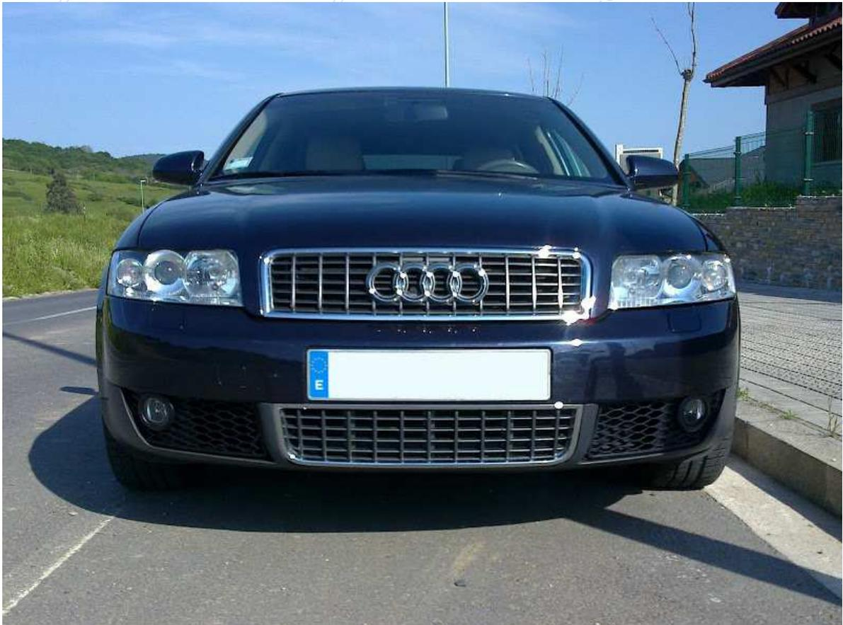
El cambio completa el anteriormente realizado de colocación de las rejillas centrales superior e inferior del S4. El caso es que a mi no me gusta el paragolpes completo del s-line, por lo que he optado por sustituir sólo las rejillas.
