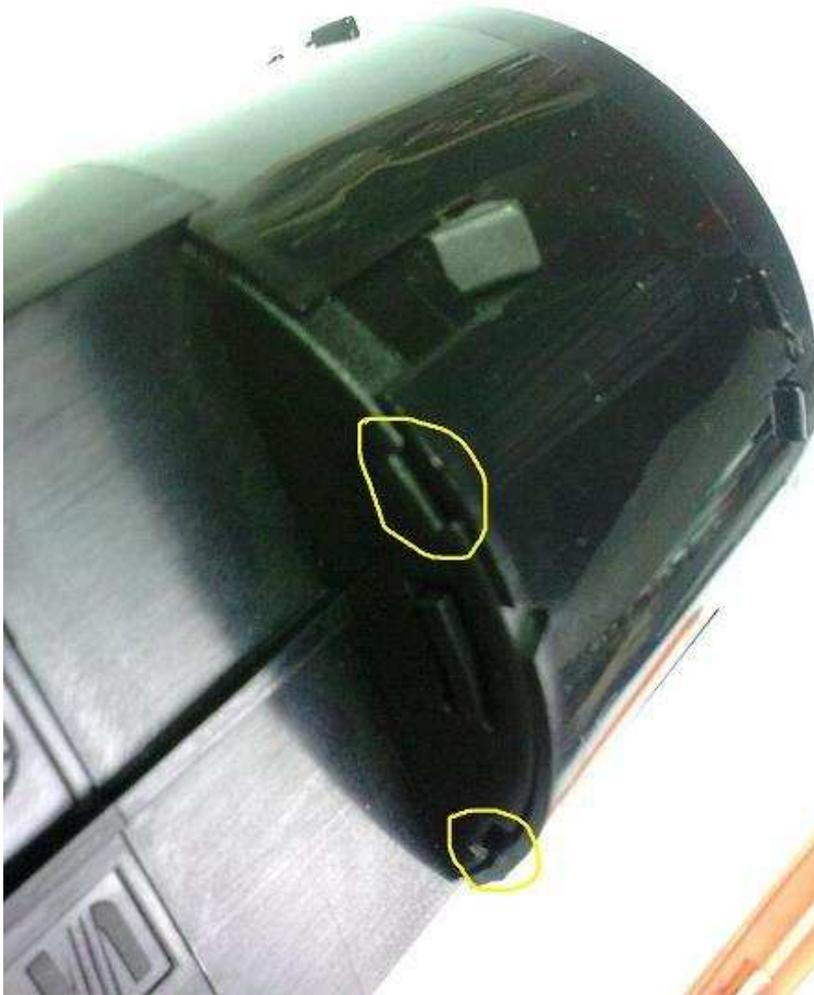
Hacemos palanca con un destornillador pequeño en las ranuras marcadas con amarillo (Atención: hay dos de cada lado), y despacio vamos tirando del capuchón hasta que éste se libere de la parte frontal del comando, luego para poder retirarlo completamente debemos destrabar con el mismo destornillador las cuatro pestañas que se ven en la foto (dos a cada lado).
