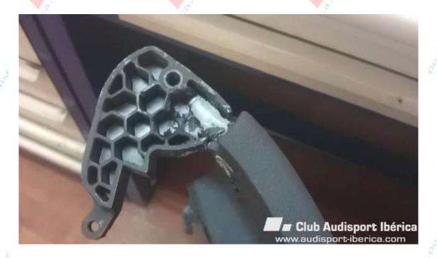
Después de esto lo que hice fue rellenar el hueco de la bisagra con el araldit dos componentes, como podéis comprobar la bisagra la vacíe para poder alojar el tornillo con otro taco y poder llenar todo ese hueco con el araldit.
