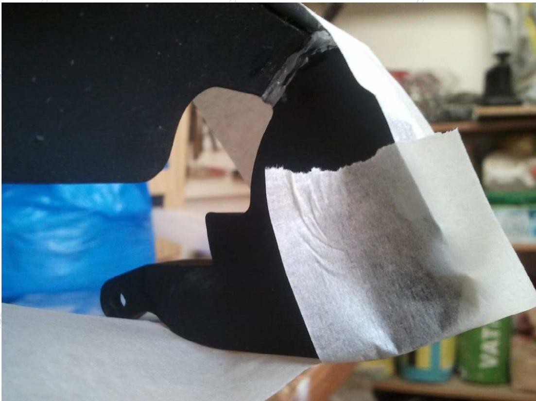
Esperamos a que seque el Nural y el conjunto quede rígido (unas 12 horas). Retiramos la cinta de carrocerero y el trabajo está casi terminado. Solo queda repasar un poco la soldadura con una Dremel o un limatón, con el fin de alisar los bordes y evitar que se note la soldadura:
