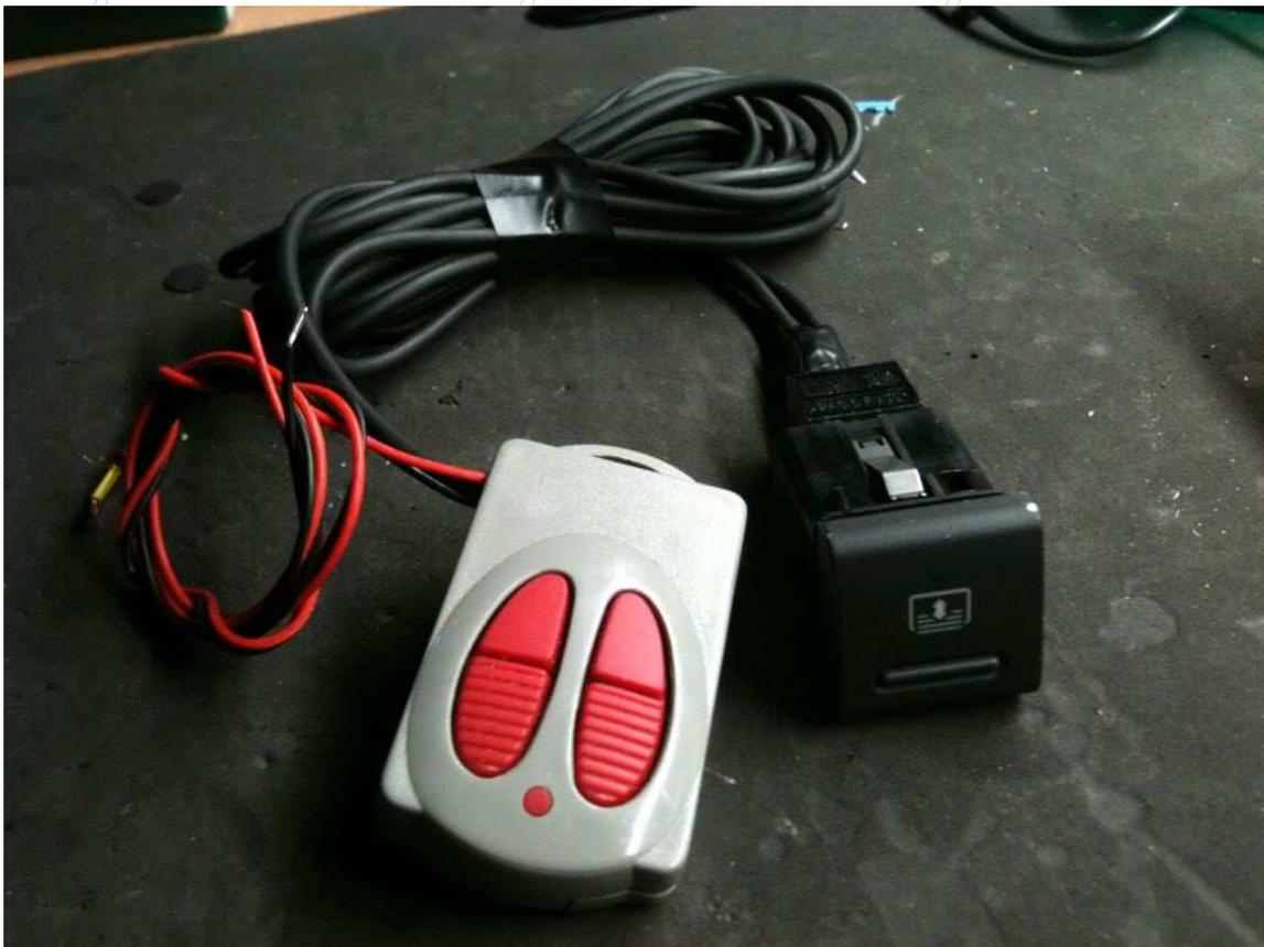
Aquí tenéis como ha quedado mecanizada y lista para poner en su sitio la tapa "ciega" con el LED de ON/OFF y la ventana redonda que deja pasar los infrarrojos hacia el fototransistor que recibe las ordenes del mando(mi peque lo flipa ya que desde atrás maneja el cotarro 🙌 )
