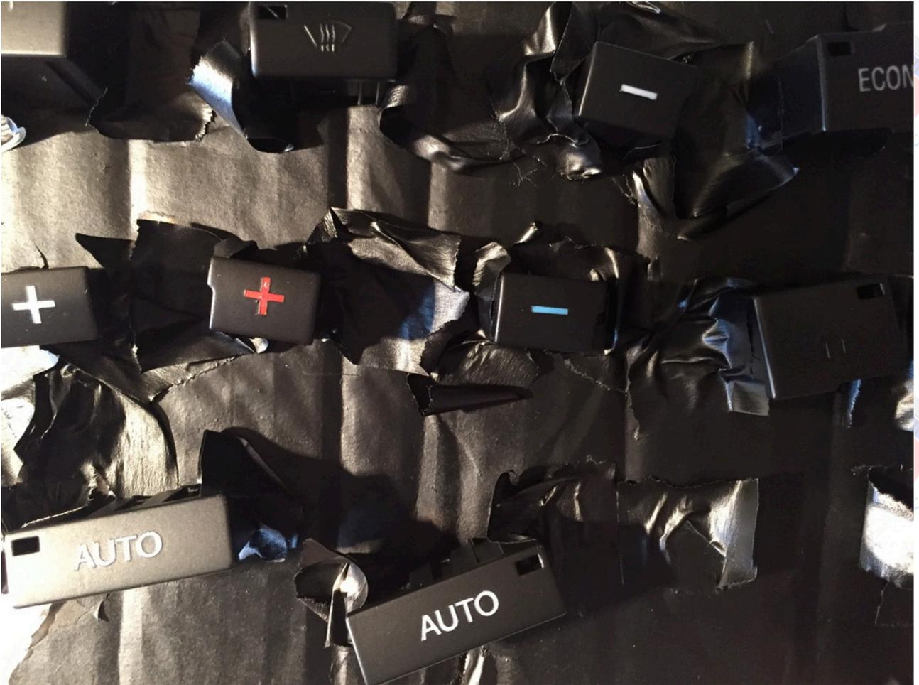
Vamos retirando los vinilos y nos va quedando algo así. ¡Parece que funciona! Para retirar los vinilo encontré que la manera más cómoda es "pinchar" sobre un extremo de ellos sin miedo utilizando un destornillador de relojero. Después es ir tirando suavemente.
