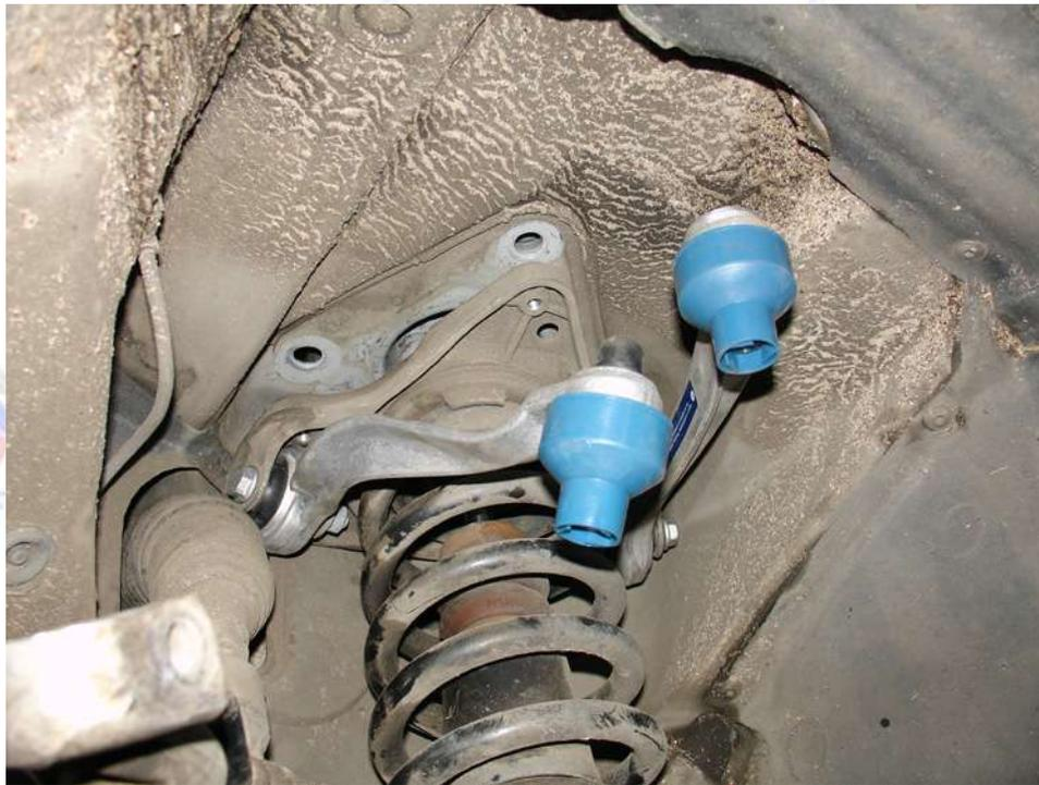
Un truco: enganchamos el amortiguador antes de conectar el brazo a la rueda... jejeje, tampoooooco teníamos material para comprimir el muelle 🤪
