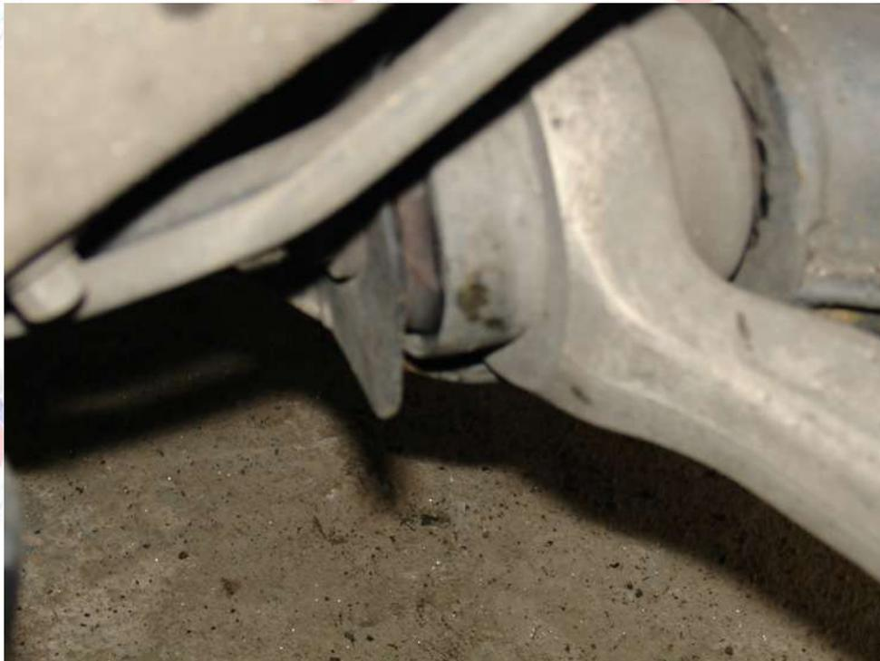
Y el brazo inferior que sujeta al amortiguador y a la horquilla de la estabilizadora
