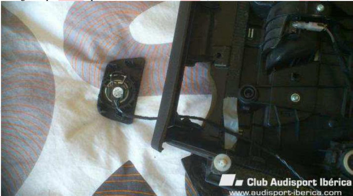
Bueno pues después de tenerlo todo fuera tenemos que sacar el tweter de la propia rejilla, para ellos tenemos que presionar de adentro hacia afuera de las patillas marcadas en la foto (como siempre metidas en el siguiente mensaje que aquí no cabe jejejeje)
