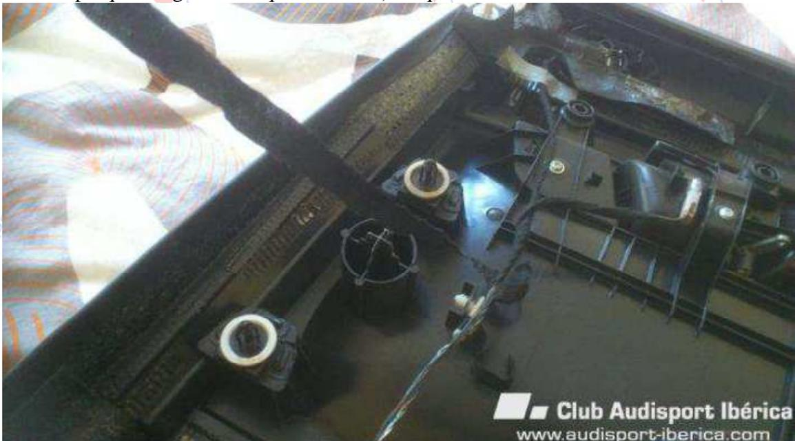
y una vez que tengamos la instalación desencintada procederemos a sacar el tweter, primero en conjunto con la rejilla presionando sobre estas patillas y empujando hacia afuera
