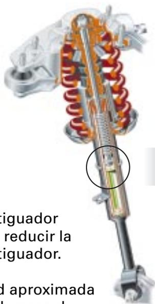
Dos ranuras en el tubo amortiguador funcionan como bypass para reducir la resistencia del émbolo amortiguador.
