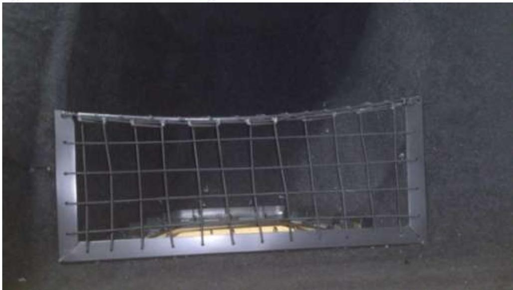
Al ir trenzando la goma, en el centro se nos irá bajando hacia el suelo por la tensión, no problem, cogemos una varilla (de un stors por ejemplo) la cortamos a medida, si es negra mejor, la sujetamos a las esquinas con unas bridas plásticas y sujetamos la red a la varilla mediante un cordón de tela plano para que no quede bruto, tal como se muestra en la imagen anterior.
