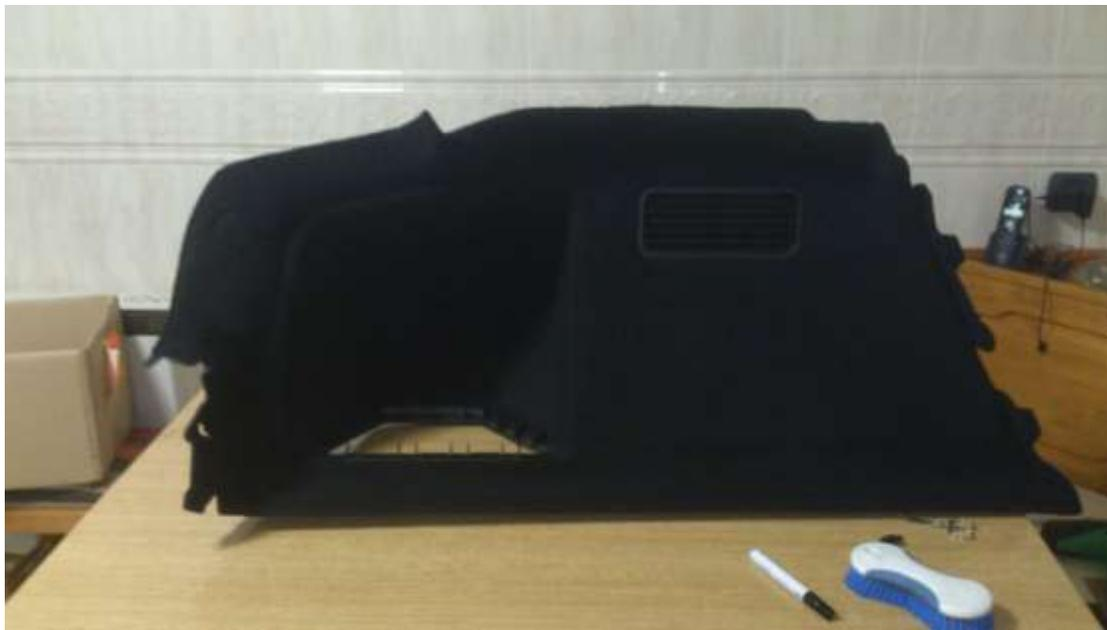
en este hueco yo le hice una red, usando el ángulo de PVC y la goma elástica de cola de ratón, a los laterales yo le di unos 15cm y le redondee los cantos, cortando las dobleces para facilitar los ángulos tal que así.
