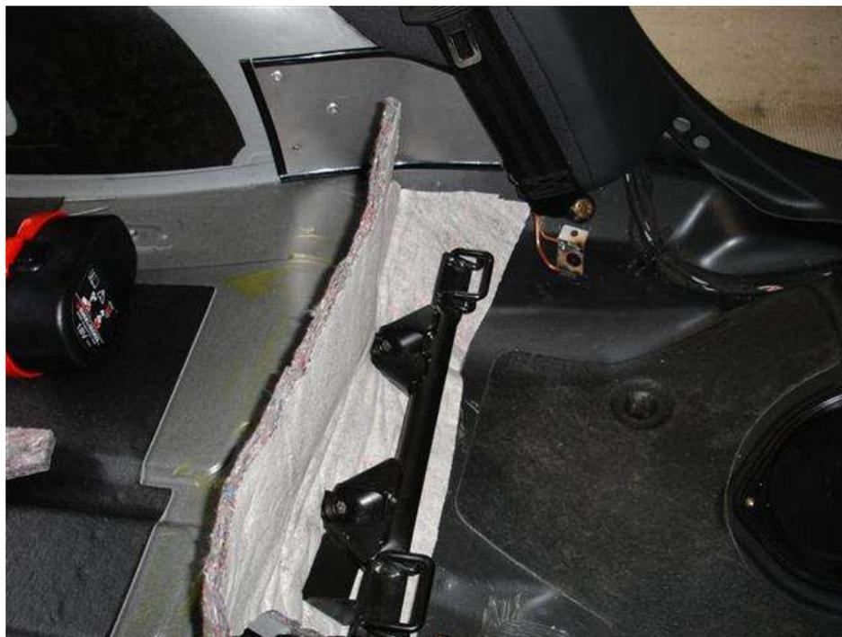
Una vez tenemos el soporte fijo montado, montaremos los laterales de los asientos (no los respaldos, sino la parte lateral, que es la que va collada a la chapa, y que nos aguantara el soporte de cierre y montaremos dicho soporte, que no es más que un tornillo, que pasa por el agujero de la chapa:
