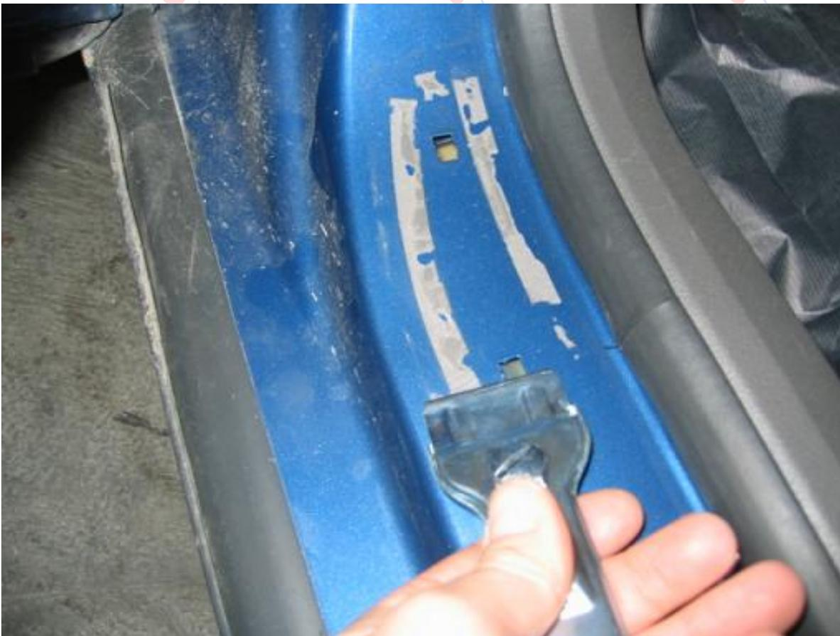
Ésto es el estado en el que queda la parte inferior de la talonera antigua; podéis apreciar los restos de pegamento y unos pequeños pipotes, que encajan en los agujeros que a tal efecto tiene la carrocería
