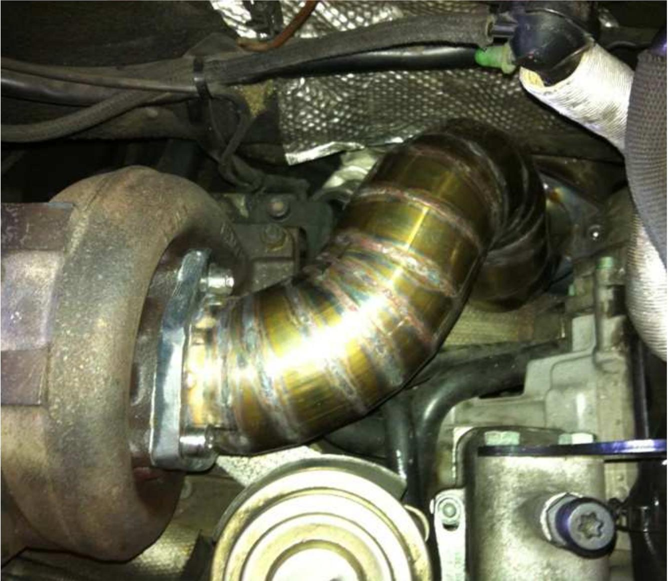
Las tuercas las he sustituido por nuevas, estaban asquerosas de oxido y del calor, he cogido en Audi, especiales para alta temperaturas, lleve la referencia del ETKA y 0'34€ cada una, también he cambiado las dos juntas, en Audi 13€ las 2.
