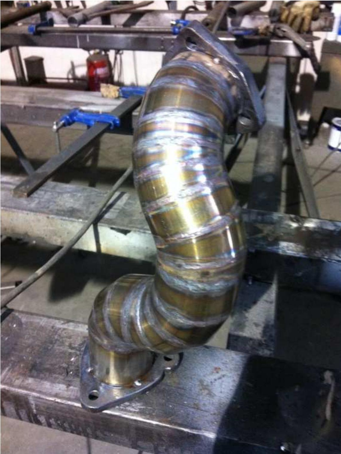
Y la downpipe terminada y montada, para meterla no ha costado tanto, por abajo hemos soltado la tuerca de sujeta el tramo intermedio y se hace muy fácil apalancado con un barra de ña, en 10 minutos estaba montada, otra cosa es atornillar las 3 tuercas, hay que volver a meter llaves y alargaderas hasta que se atornillan, con paciencia se hace.
