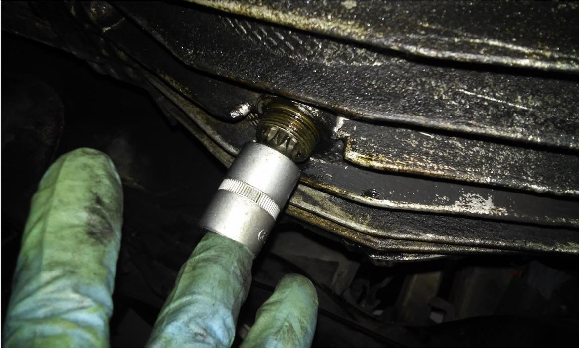
abrimos el tapon de vaciado y el de llenado(Allen de 17 junto al palier del lado del conductor)
