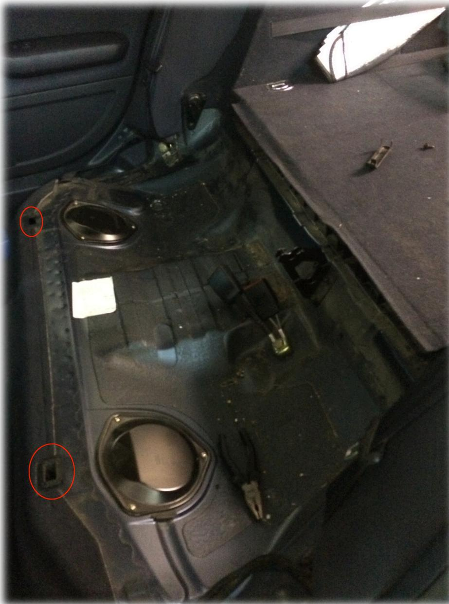
Una vez tenemos la banqueta sacada empezaremos para sacar la parte del respaldo. Primero de todo para así ahorrarnos trabajo para luego sacaremos la parte de la cinta del cinturón que va en el respaldo doble. Lleva una pieza de plástico para que la cinta quede tensa y las dos partes queden cogidas, esa la sacamos simplemente desenganchado.
