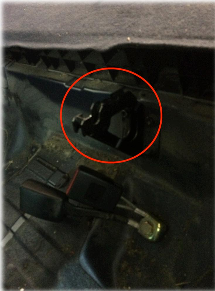
Esta es la pieza que hay debajo del tornillo y la que sujeta por en medio a los dos respaldos. Para sacar los respaldos se han de sacara uno a uno. Se tiene que levantar un poco la parte central y luego tirar para fuera.
