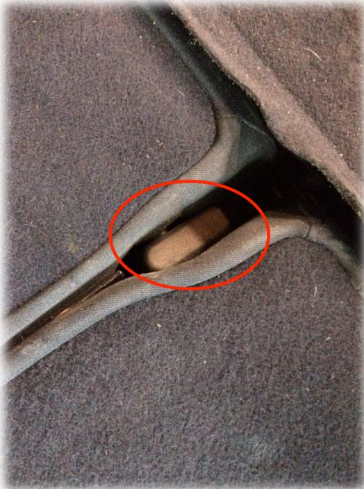
Este es un plástico protector que con la ayuda de un destornillador plano haciendo un poco de palanca por la parte izquierda de la imagen sale fácilmente. Después podremos ver un tornillo de torx y es el que debemos sacar.
