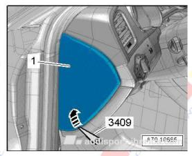
Posteriormente, quitamos los 3 tornillos existentes donde se indica en la ilustración. Con una llave de vaso de 8 mm es ideal.
