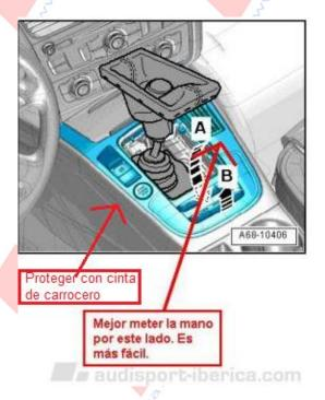
3) Una vez fuera toda la pieza, darle la vuelta para trabajar sobre los conectores de la botonera a sustituir. Las grapas o presillas que hay en la parte trasera son metálicas. Para evitar accidentes, es mejor protegerlos temporalmente con cinta de carrocero.
