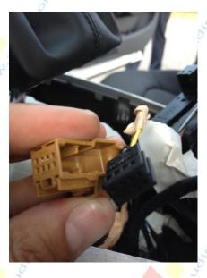
Fijaos en los cables ya existentes para introducir el nuevo de la misma forma. Al entrar el cable, una pestaña lo coloca en su posición y ya no sale.
