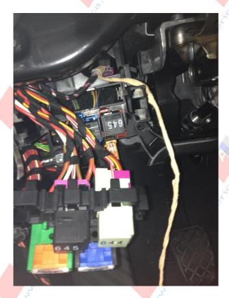
8) Ahora para montar el guarnecido, fijaros en el detalle que nos han dejado preparado desde fábrica. Podéis utilizar las pestañas interiores del guarnecido, para colocar el cable.
