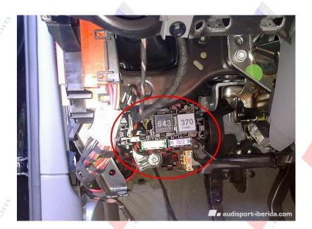
Los óvalos marcan la localización de las pestañas. Se liberan y tiramos hacia nosotros. Esta pieza completa puede dejarse a la derecha. No hace falta desconectar los fusibles ni relés y nos deja cable suficiente para trabajar a posteriori.
