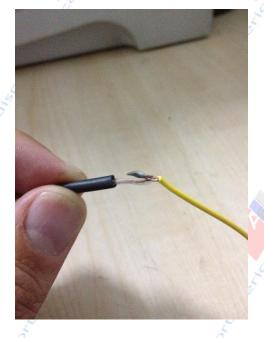
Una vez soldado el cable y ampliado en longitud, puede recubrirse con cinta de vellón o esparadrapo con la idea de no golpee piezas plásticas o guarnecidos del coche y evitar "grillos".
