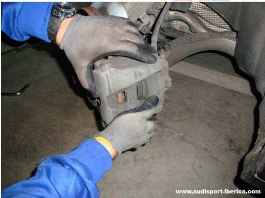
Una vez quitada la pinza la sujetamos detrás del disco con cuidado de que no se caiga y lo más importante que no se suelte el manguito del líquido de frenos, encontraremos las pastillas de freno, quedando la pastilla posterior sujeta por el cable del testigo
