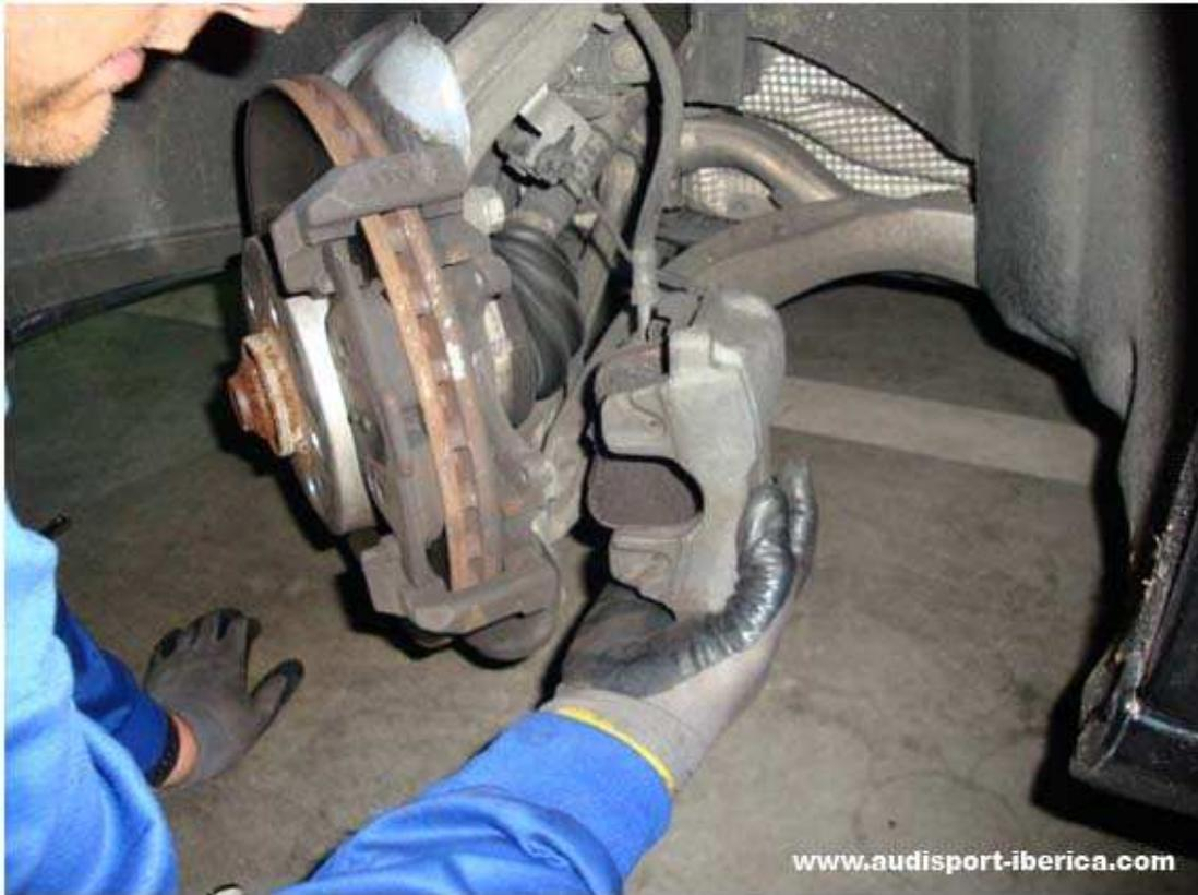
Ahora nos queda soltar el conector del testigo, lo quitamos del soporte metálico (tirando hacia el disco) y el conector sale presionando una pestaña que tiene, una vez apretada la pestaña solo hay que tirar de él
