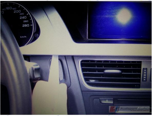
Luego sacaremos la tapa del lado del conductor de fusibles y tenemos que quitar los 3 tornillos que sujetan el botón de luces.
