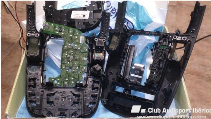
Esta es la placa de circuito principal multicapa de la consola nueva en donde se encuentran los botones, los led's y el resto de la electrónica que cumple su función originalmente con el resto del sistema del coche.
