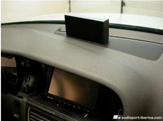
El de arriba es el soporte para la pantalla de 7" y la chapa de abajo, la que va atornillada en donde estaba la original
