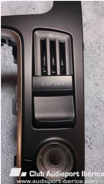
Este es el desmontaje del pulsador. Con unos palillos se puede desencajar, este botón y otros de la consola. La chapa pequeña es la que hace de muelle para el pulsador y que tuve que sustituir.
