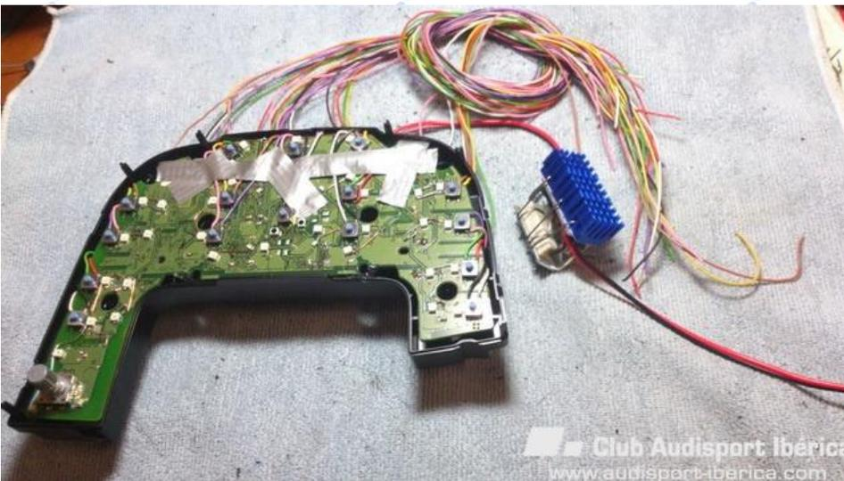
Aquí podéis ver las dos versiones que intenté. La primera placa que veis atornillada es la de un teclado normal y corriente y todos los contactos metálicos que se pueden ver, son los que van conectados a todos los botones del teclado, como podéis ver en la foto inferior. Para ello hay que seguir las pistas o bien con un polímetro averiguar los contactos al hacer cortocircuito al pulsar uno de los botones, que en este caso no están como se puede ver.
