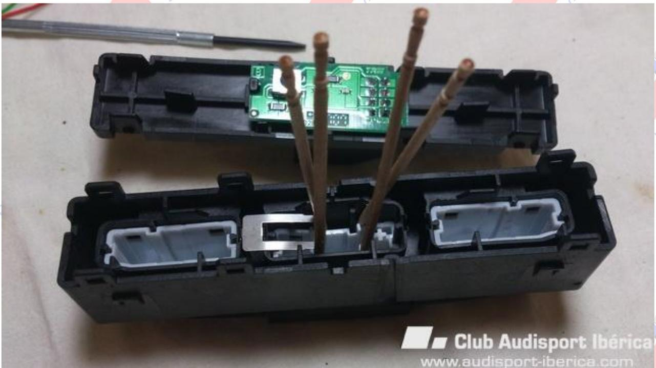
Esta es la parte central del pulsador una vez cortado en tres trozos. Después de cortarlo ni sirve el muelle original, ni las paredes encajan para cerrarlo.
