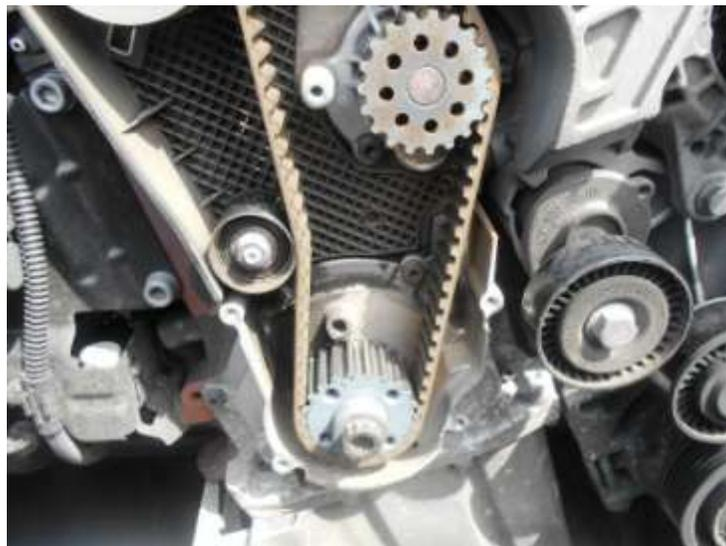
Ahora ya tenemos que empezar con el bloqueo de todo. Hay que mover el cigüeñal en sentido horario hasta que la marca que tiene en uno de sus dientes quede enfrentada al triángulo del útil de bloqueo. Ponemos dicho útil y tiene que quedar sujeto enroscándose en el agujero que se ve en la foto encima de la rueda:
