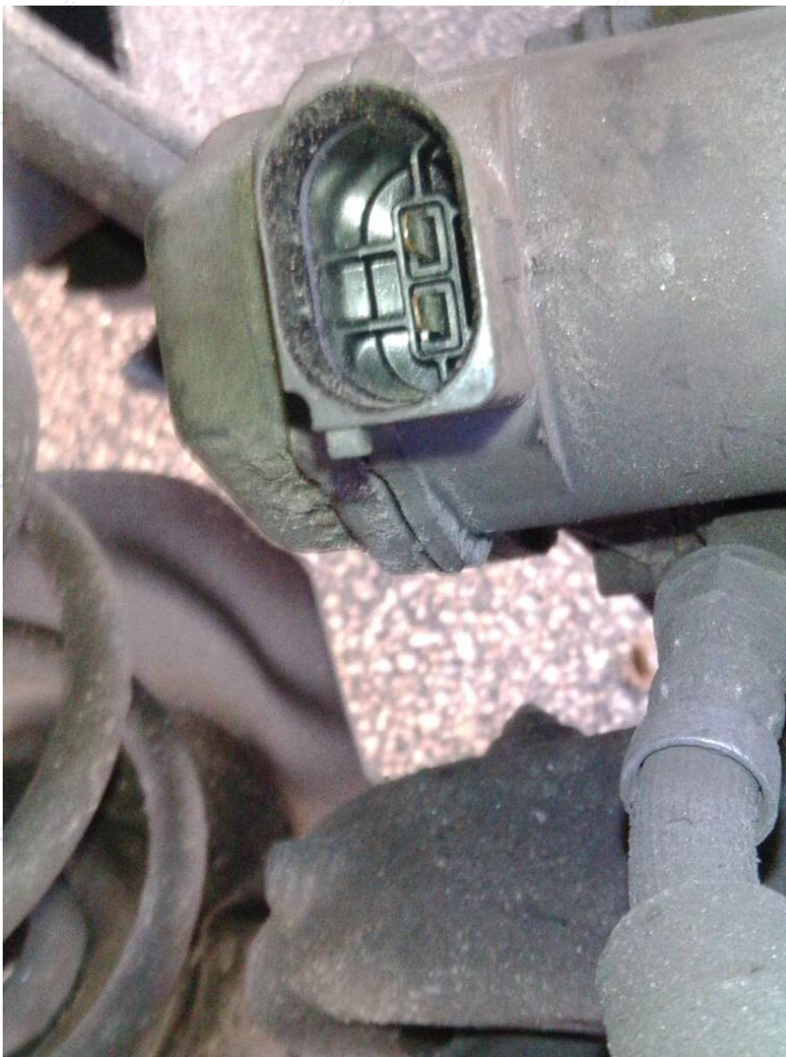
Oíréis un ruido de cuando actúa el motor, después de unos 5 o 7seg comprobar con la ayuda del destornillador haciendo palanca que el pistón se va retrayendo. Si hiciera falta retraer mas el sinfín, lo conectaríamos un poco mas.
