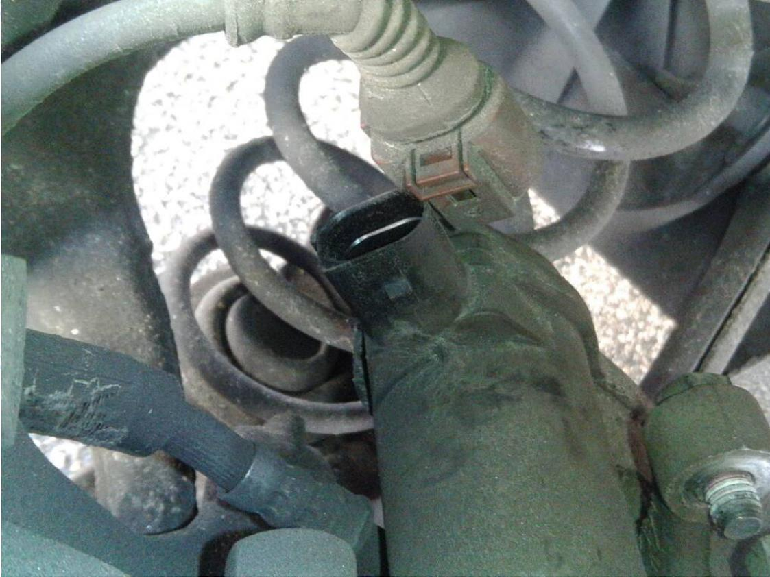
Y se conecta el cable positivo en el pin superior y el negativo en el pin inferior para retraer el sinfín y ASI dejar el pistón libre.
