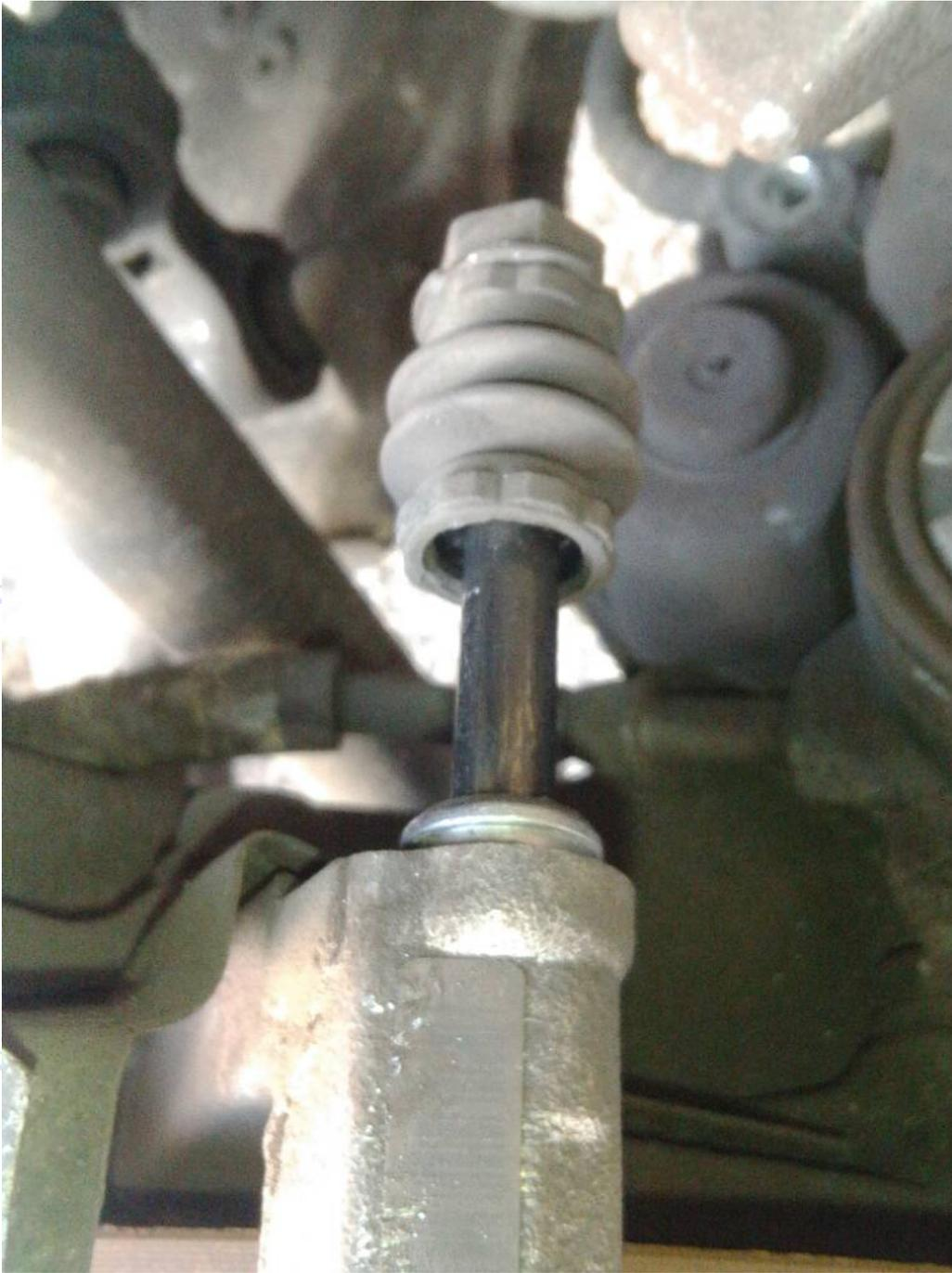
luego montar todo enchufar y encender el coche y pisáis el freno (ojo sin poner el freno de mano) unas cuantas veces y ya luego ponéis el freno de mano para que ajuste bien.
