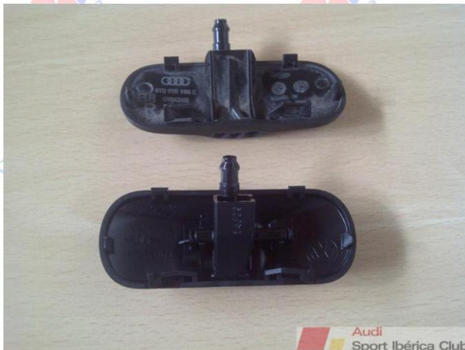
Se ve la diferencia, uno tiene tres agujeros y otro uno alargado. Tiene un tornillo con cabeza torx para regular la altura. Ojo, es de plástico y, si se fuerza, se puede dar de sí la cabeza.
