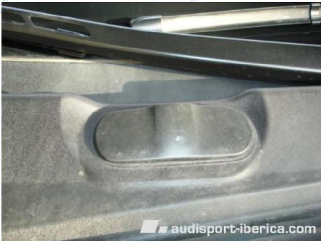
Se saca fácilmente con un destornillador plano, haciendo palanca.
